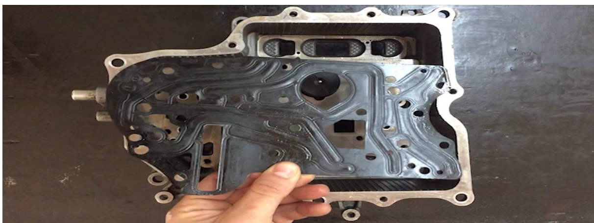
Рисунок 70-Установка прокладки на нижний гидроблока Третий этап: Установка верхнего гидроблока (рисунок 71).
