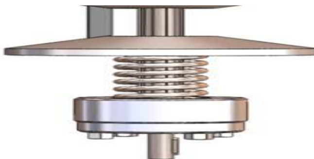
Рисунок 32 – механизм самонатяжения ремня.
