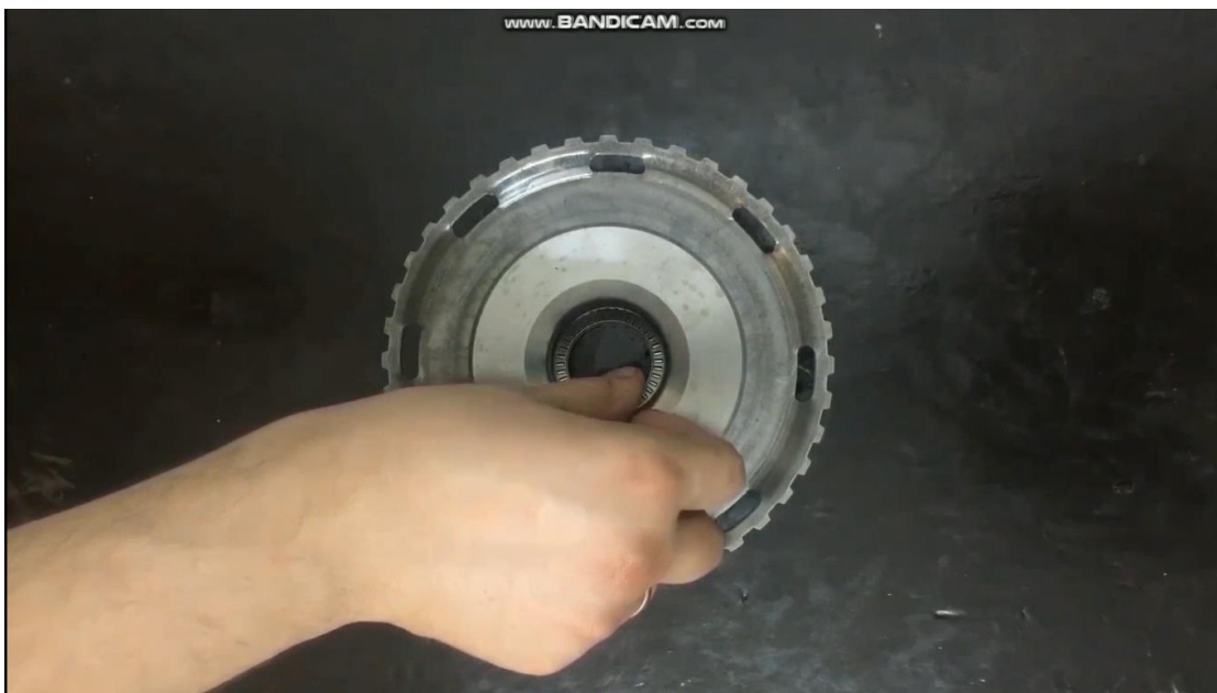
Рисунок 96 - Установка подшипника в приводную втулку корпуса муфты К3
