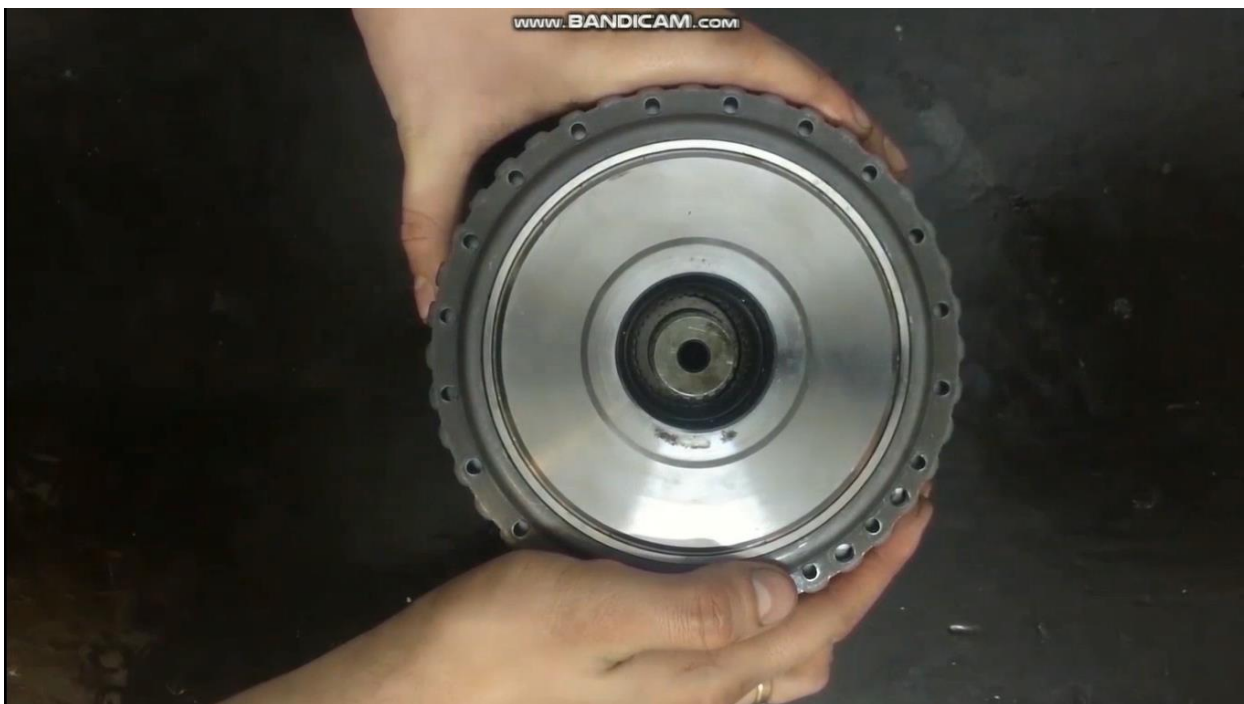
Рисунок 98 - Сборка переднего планетарного редуктора с муфтами К1 и К3
