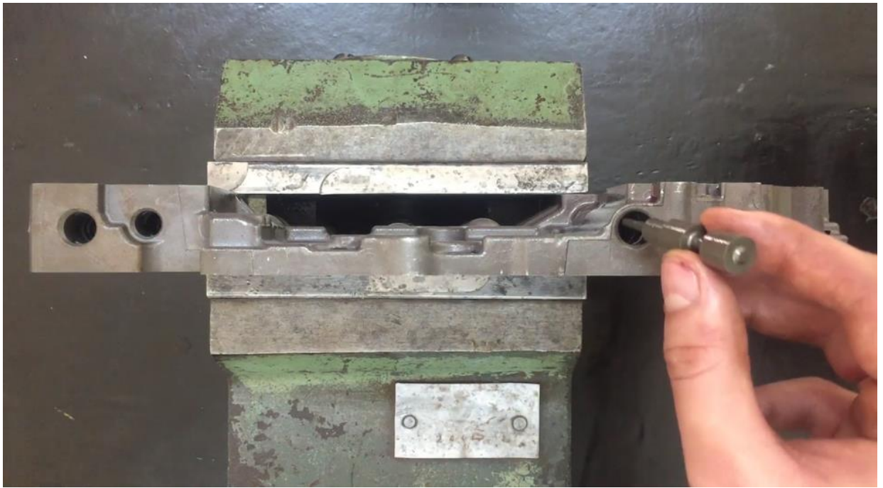
Рисунок 75 – Сборка верхней гидроплиты
