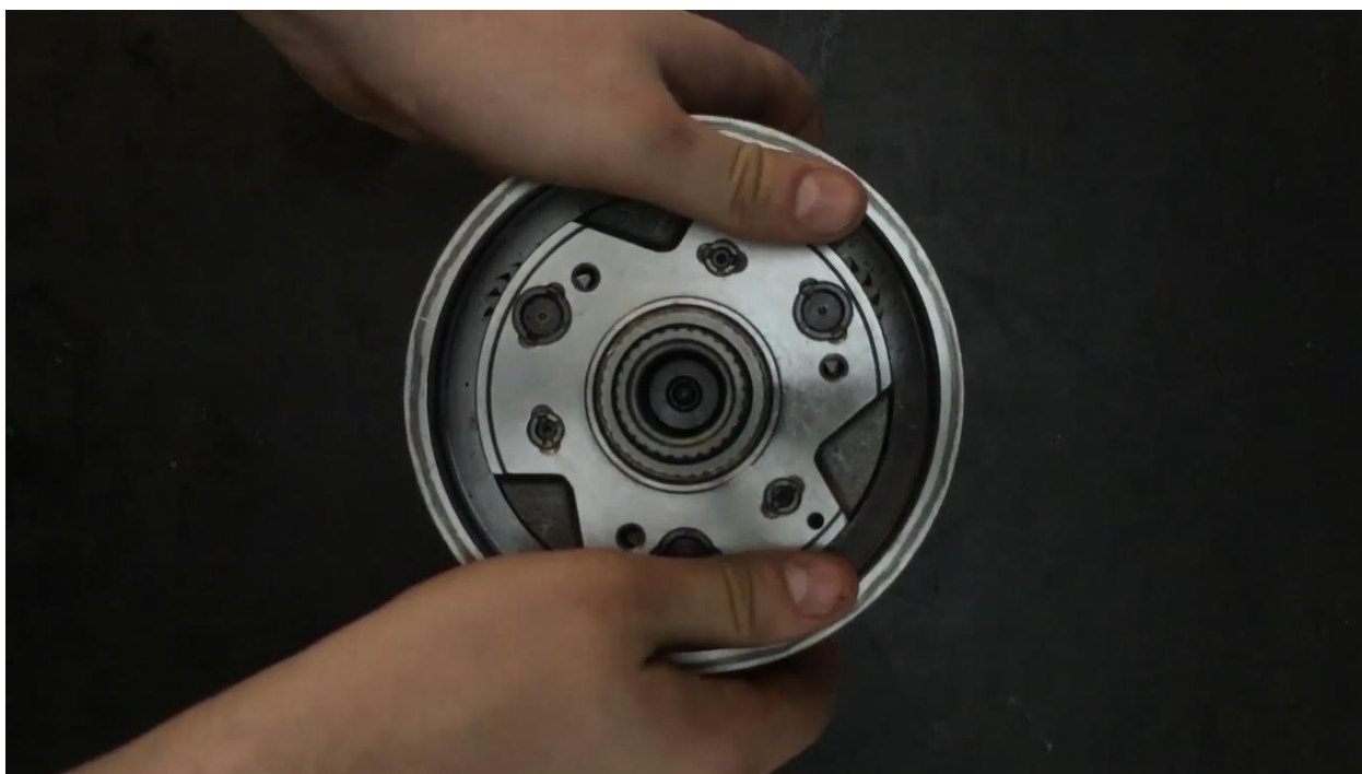
Рисунок 95 - Сборка заднего планетарного редуктора и муфты К2
