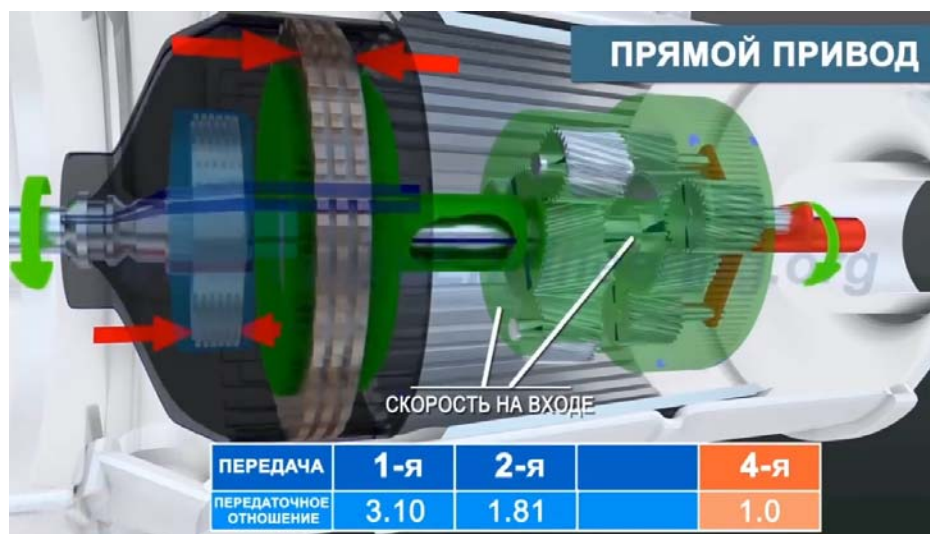
Рисунок 29 – схема включения 4-ой передачи.
