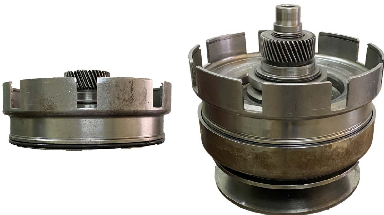
Рисунок 77 – установка поршня подвижного шкива.
