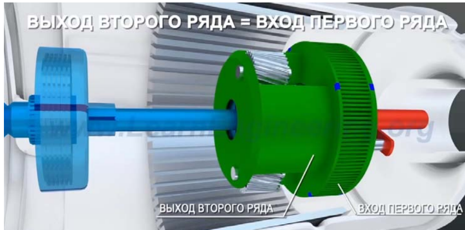
Рисунок 28 – схема передачи крутящего момента при замыкании фрикционов С1 и С4.
