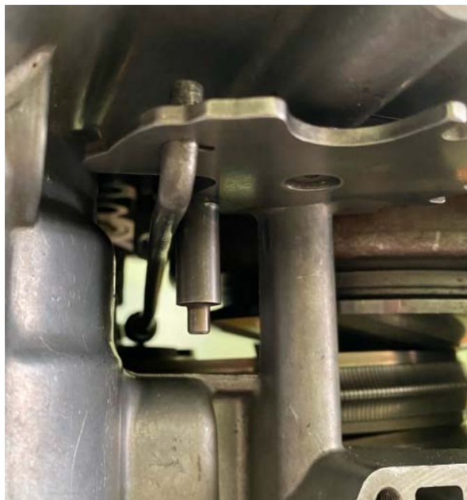
Рисунок 93 – установка штока положения «Р» в сектор селектора выбора режима движения.
