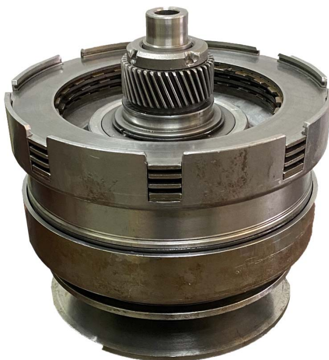
Рисунок 81 – установка сцепления ведущего вала.
