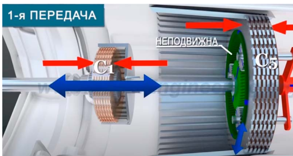
Рисунок 23 – схема включения первой передачи.
