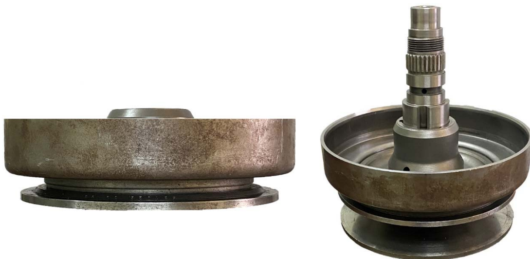
Рисунок 76 – установка подвижного шкива с цилиндром.
