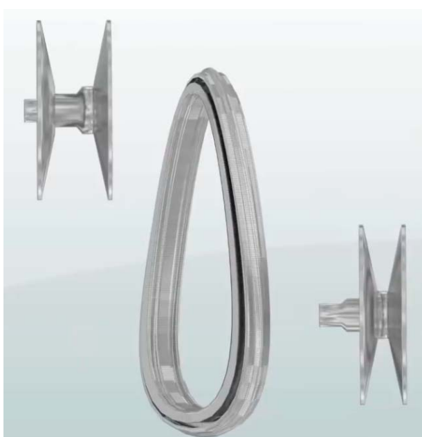
Рисунок 54 – два шкива и металлический ремень.
