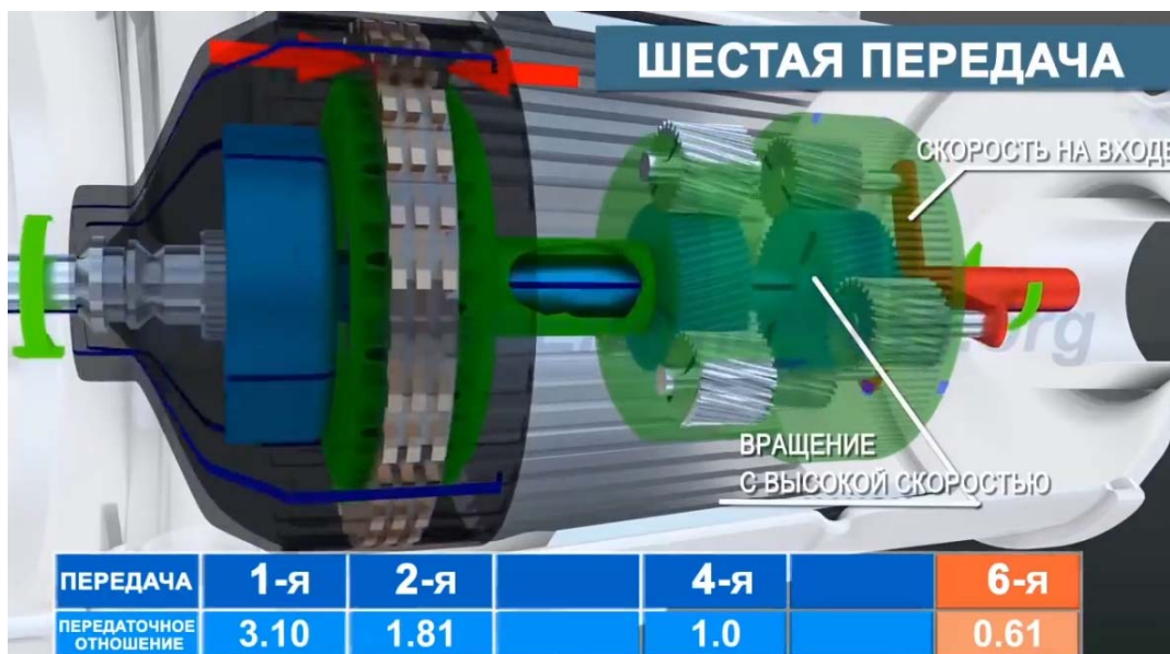
Рисунок 31 – схема включения шестой передачи.
