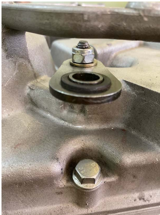
Рисунок 94 – установка рычага выбора режима движения.
