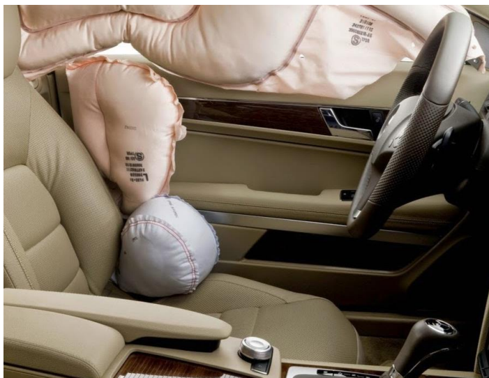
Рисунок 1.12 – Пример двухкамерной боковой подушки безопасности
