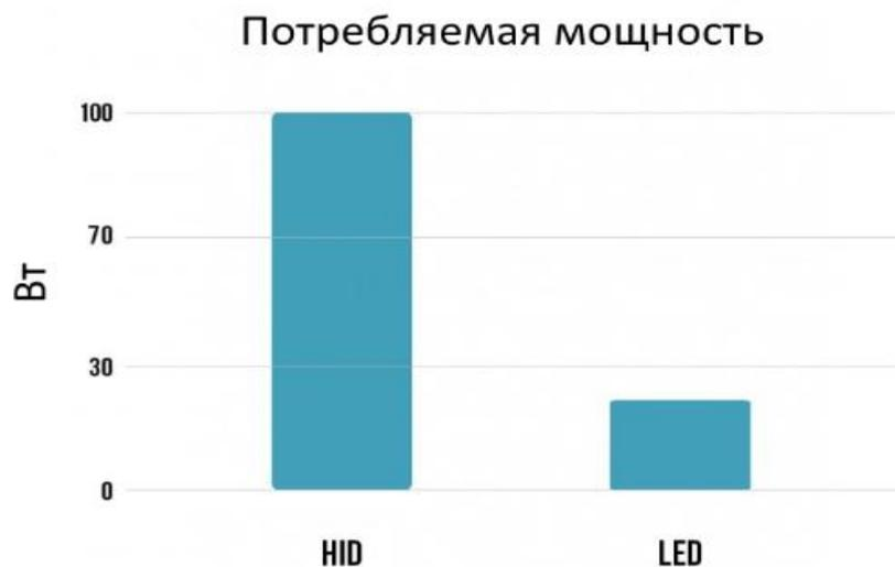
Рисунок 1.3 - Сравнение потребляемой мощности газоразрядных ламп со LED лампами обладающими одинаковым световым потоком
