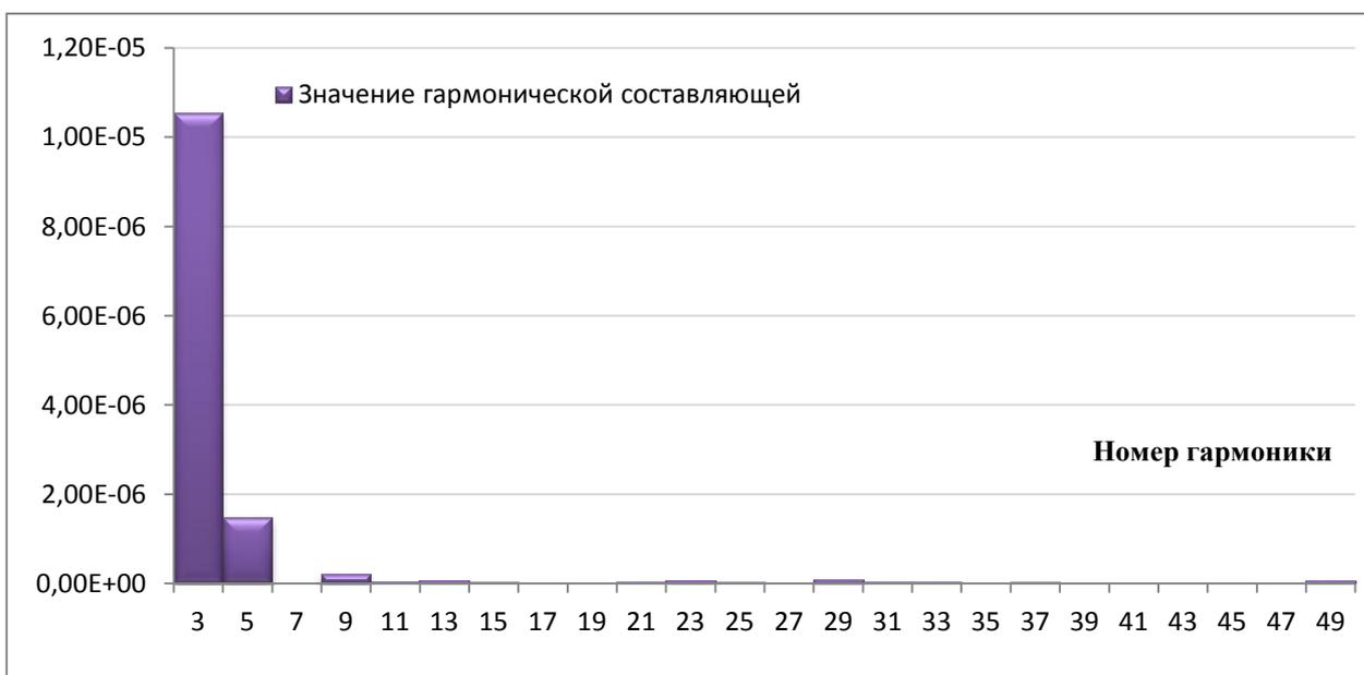
Рисунок 3.2 - Спектральный состав гармоник по току в питающей сети на одном светильнике после установки ФКУ
