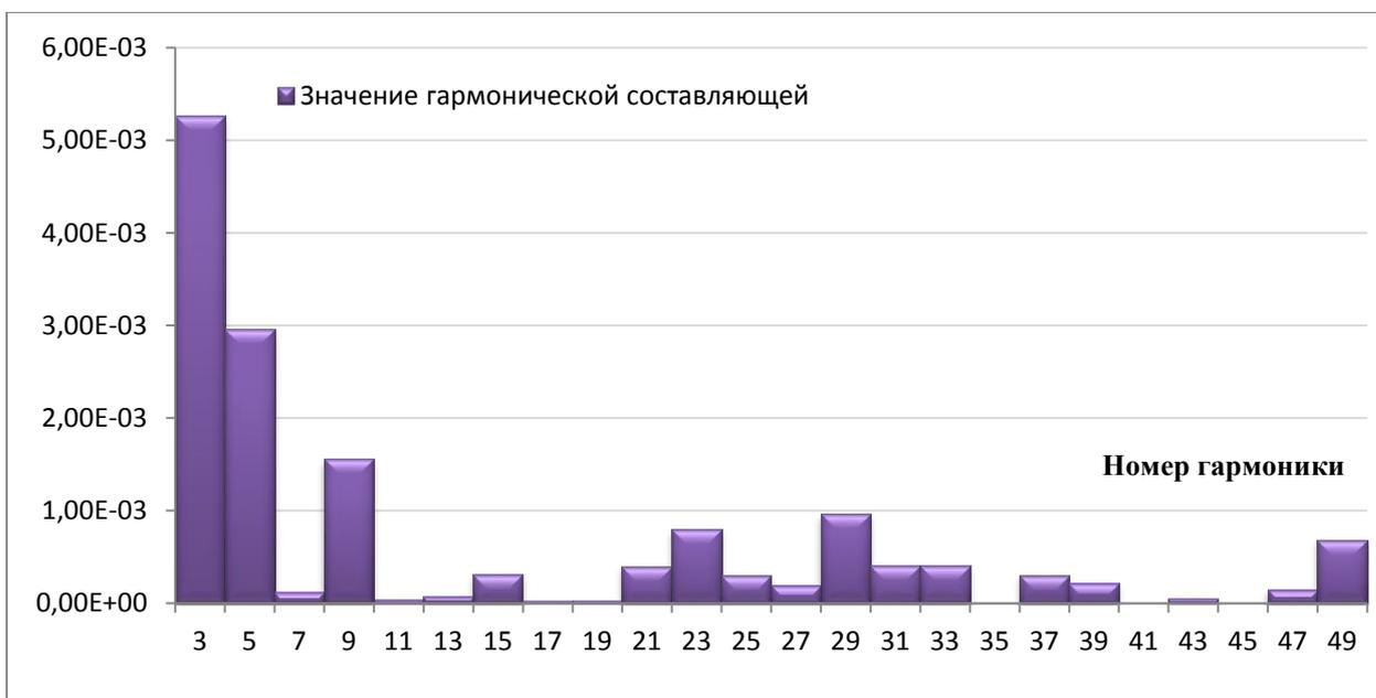
Рисунок 2.7 - Спектральный состав гармоник по току в питающей сети на одном светильнике
