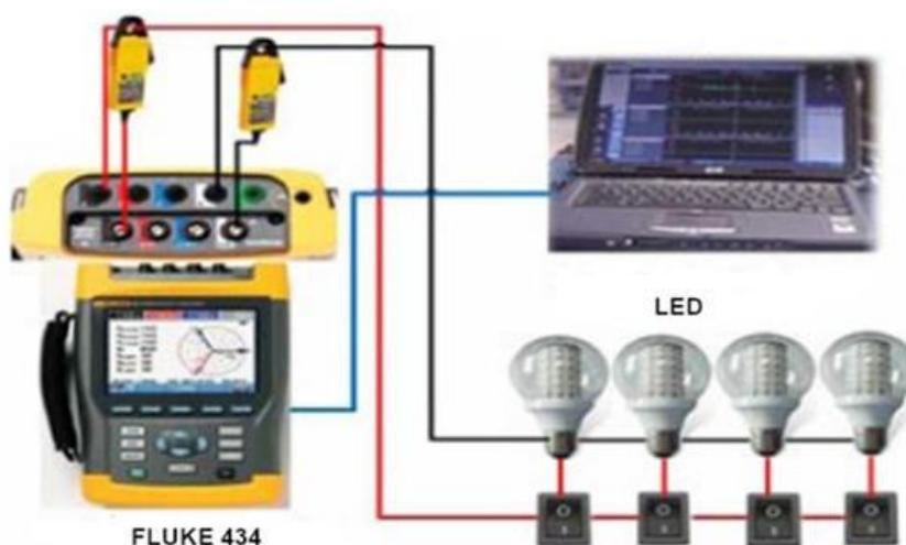
Рисунок 2.4 – Схема подключения FLUKE 434 к питающей сети СД светильников
