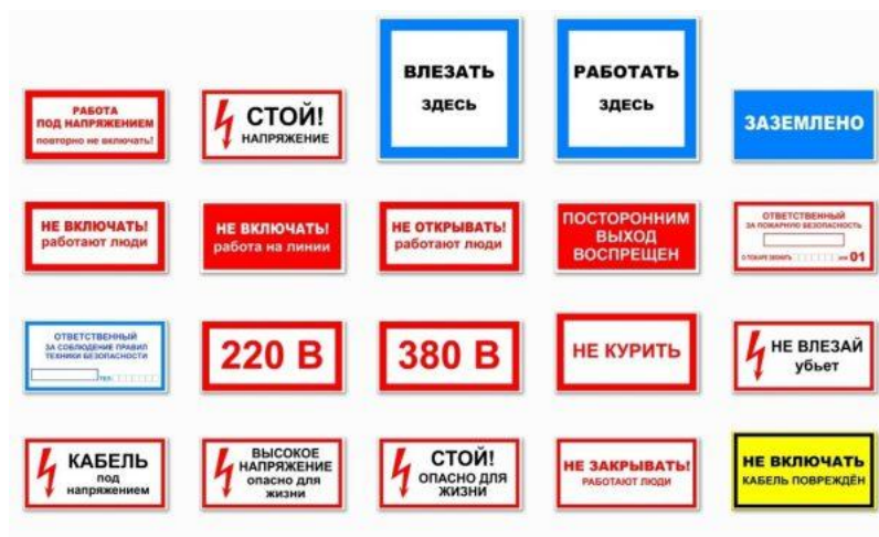
Рисунок 4.1 – Предупреждающие плакаты, которые необходимы при монтаже, ремонте и осмотре электроустановок и электрических сетей
