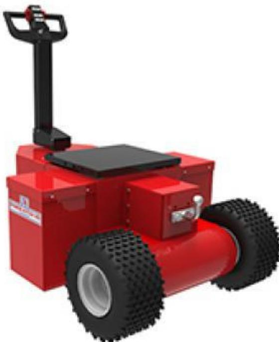
Рисунок 2.4 - Тягач Heavy Duty trailer Mover
