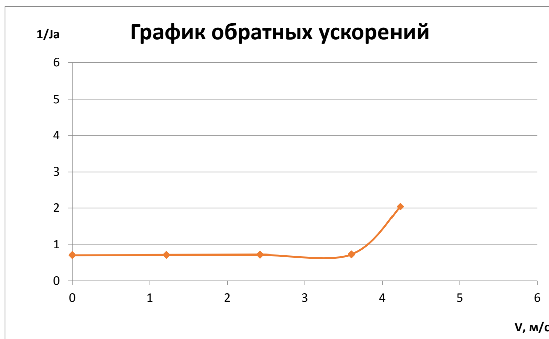
Рисунок 10 - Обратные ускорения электрокара
