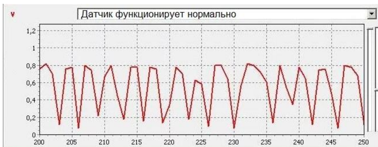
Рисунок 6 – Осциллограмма исправного датчика концентрации кислорода
