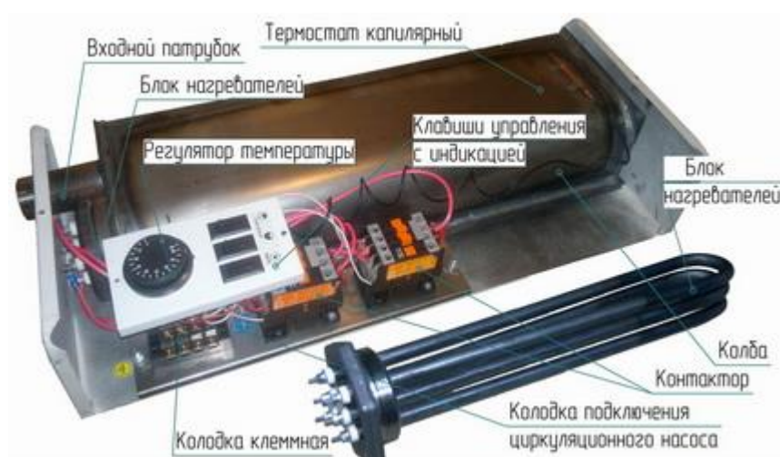
Рисунок 18 – Котёл с нагревателем типа ТЭН
