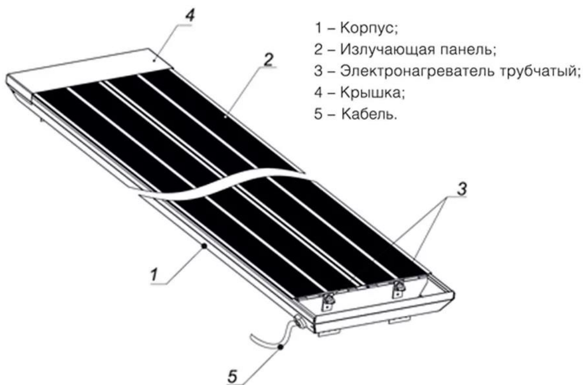
Рисунок 21 – Устройство инфракрасного излучателя
