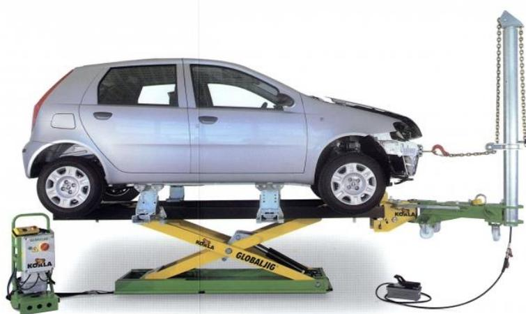
Рисунок 5 – Стенд для правки кузова GLOBALJIG KOALA
