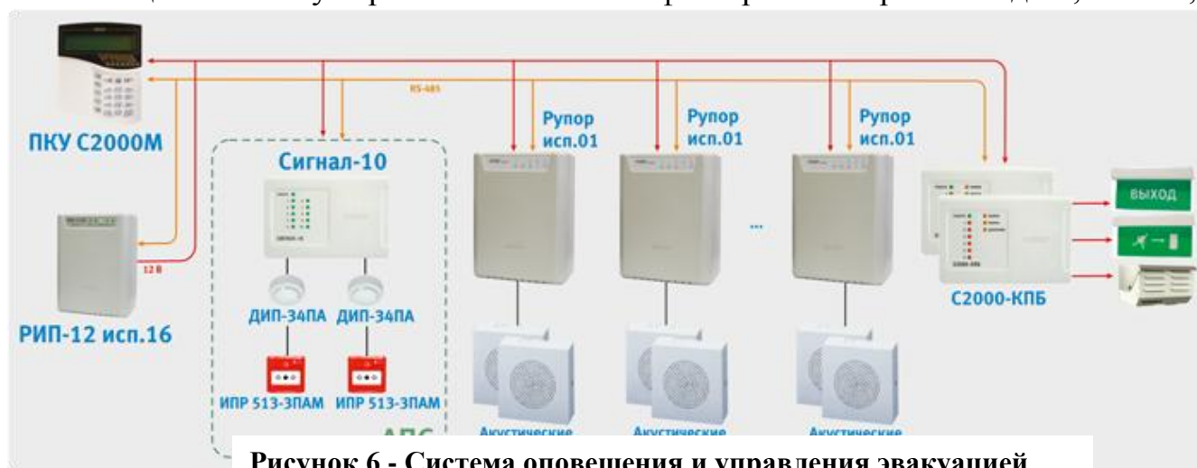
Рисунок 6 - Система оповещения и управления эвакуацией
