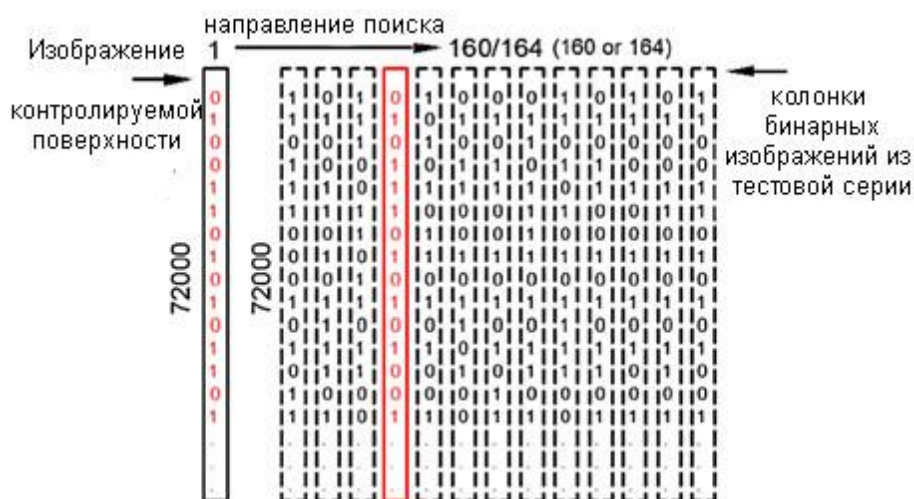
Рисунок 7 - Алгоритм поиска подобного изображения со значениями изображения поверхности
