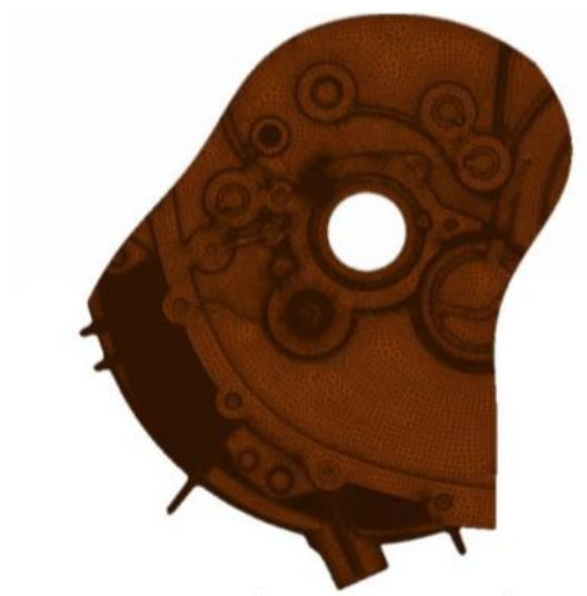
Рисунок 48 – Расчет на прочность sub-модели P12 (необработанная поверхность)
