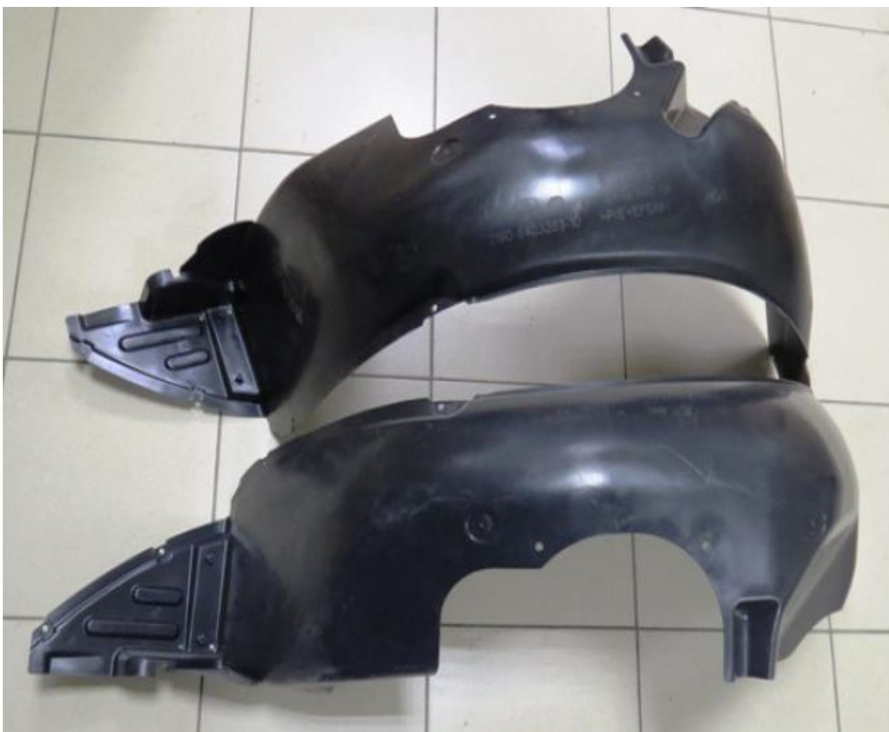
Рисунок 2.3 – Визуализация производимой продукции на термопластавтомате (ТПА) Battenfeld HM 16000 2P/12000+1000L
