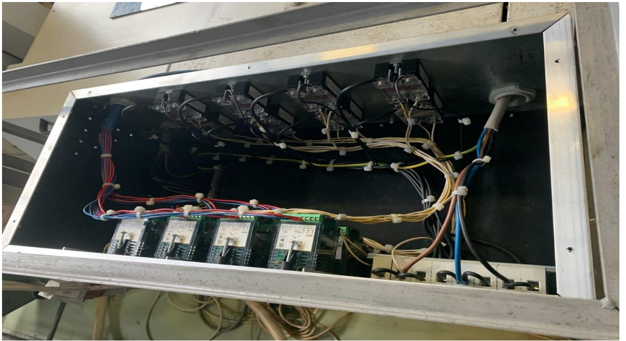
Рисунок 3.8 – Блок управления горячеканальной системой (ГКС) в сборе (без верхней крышки)
