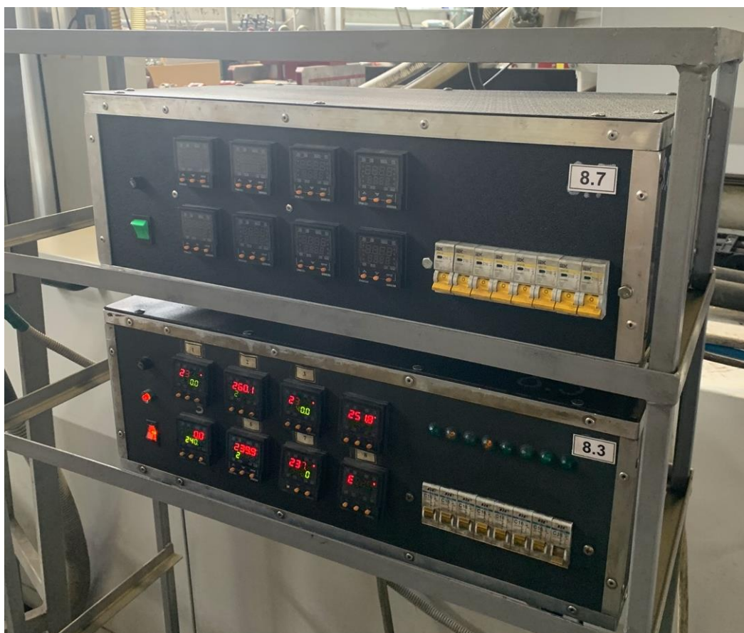
Рисунок 3.10 – Визуализация блока управления горячеканальной системой (ГКС) для термопластавтомата (ТПА) BATTENFELD
