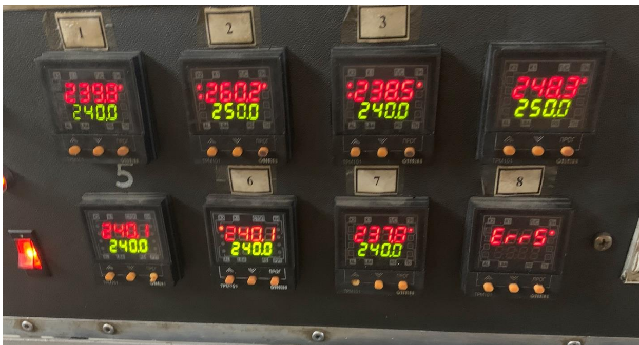
Рисунок 3.11 – Блок управления горячеканальной системой (ГКС) для термопластавтомата (ТПА) BATTENFELD в работе.
