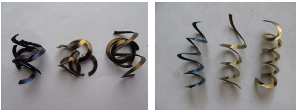
Рисунок 60 – Слева - сухая резка, в середине - сжатый воздух, справа – СЭО
