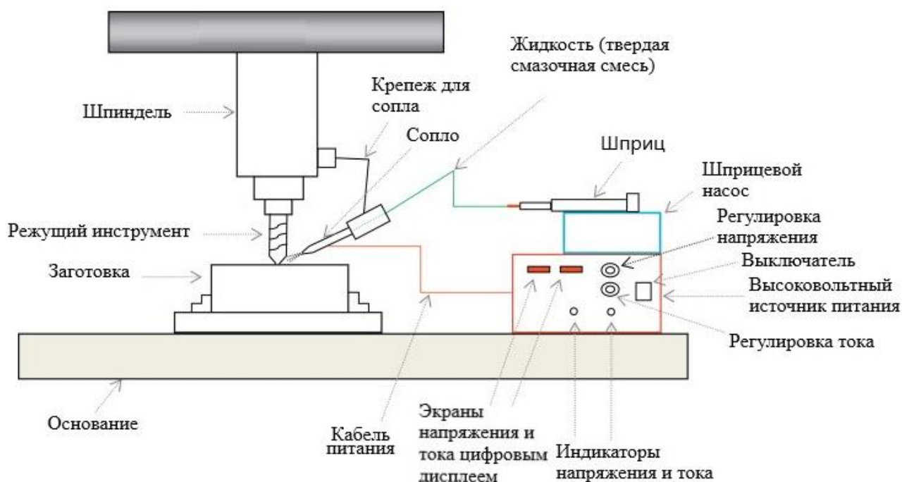
Рисунок 3 – Экспериментальная установка для твердой электростатической смазки
