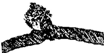
Рисунок 1.9 - Перекручивание канатов
