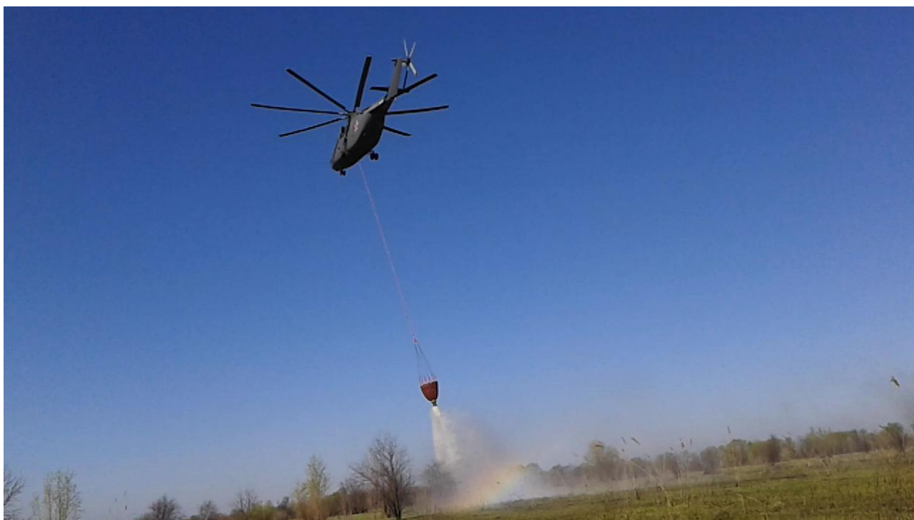
Рисунок 3 – Транспортировка ЛС, ПТВ, АСВ и сброс воды с ВСУ-15 вертолетом Ми-26ТП
