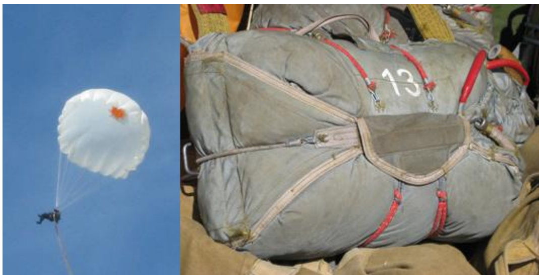
Рисунок 19 – Десантирование спасателя на запасном парашюте 3-5 при отказе основного парашюта. Внешний вид парашюта 3-5
