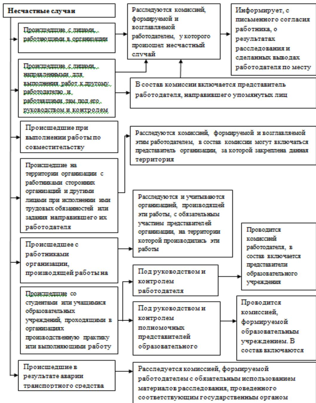
Рисунок 3.4 - Порядок расследования несчастных случаев
