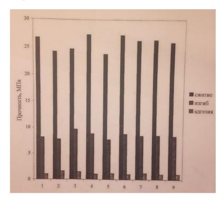
Рисунок 1.4 «Прочность на сжатие затвердевшего раствора наливного пола в возрасте 28 суток при В/Ц=0,56»[40]
