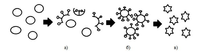
Рисунок 1.2 - Принцип действия суперпластификатора (1-частицы цемента; 2- молекула суперпластификатора).
