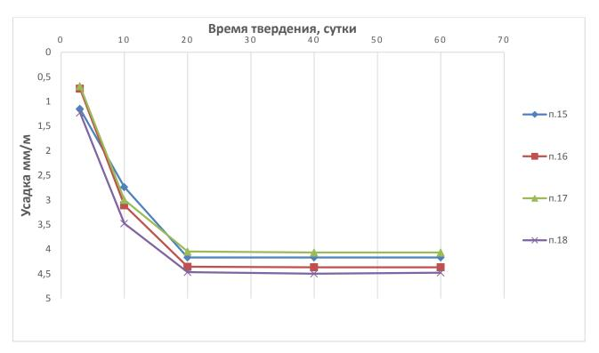
Рисунок 3.12 - Усадочные деформации цементного камня сухой смеси «Толстый» в сочетании с суперпластификатором
