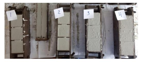
Рисунок 2.5 - Образцы наливного пола перед распалубливанием
