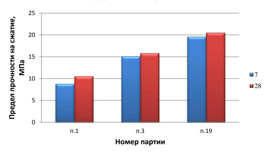
Рисунок 3.13 - Предел прочности образцов раствора в зависимости от компонентов растворной смеси партий № 1, 3, 19
