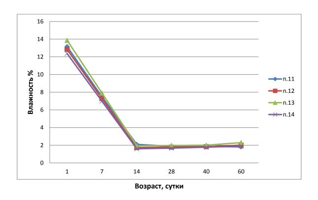
Рисунок 3.9— Изменения влажности образцов цементно-песчаного раствора с течением времени
