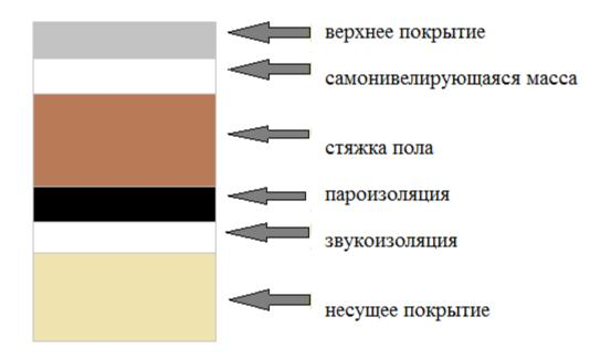
Рисунок 1.1 - Конструкция пола
