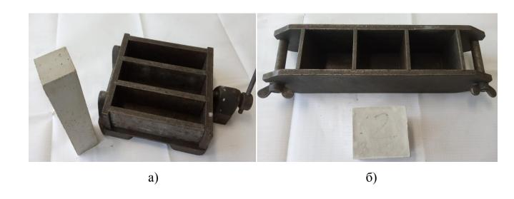
Рисунок 2.2 - Формы для изготовления контрольных образцов бетона» (a,б)
