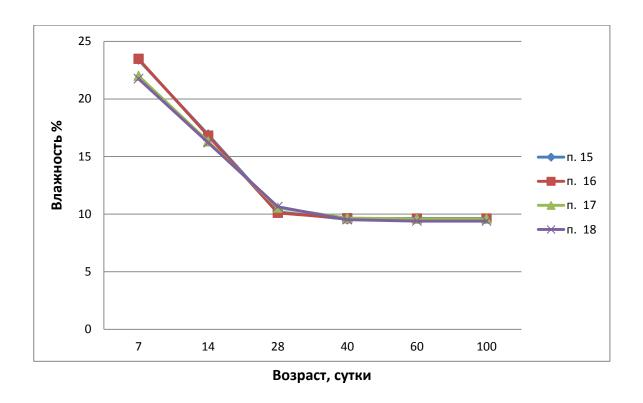
Рисунок 3.11 - Изменения влажности образцов цементно-песчаного раствора с течением времени
