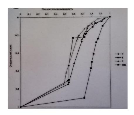
Рисунок 1.3 - Зависимость усадочных деформаций затвердевшего раствора наливных полов от влажного состояния образцов
