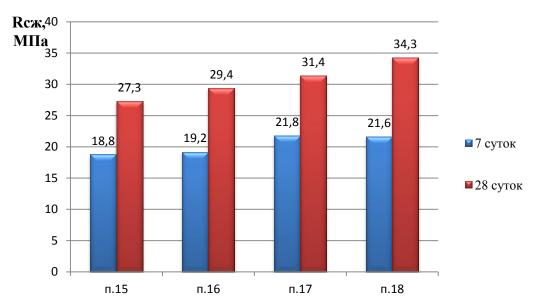
Рисунок 3.10 – Прочность образцов на сжатие
