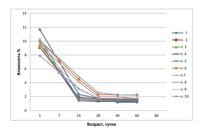
Рисунок 3.5 - Изменения влажности образцов цементно-песчаного раствора с течением времени
