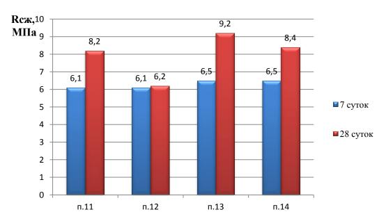
Рисунок 3.8 – Прочность образцов на сжатие
