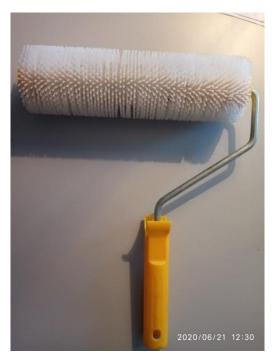
Рисунок 3.1- Игольчатый валик для распределения раствора по рабочей поверхности
