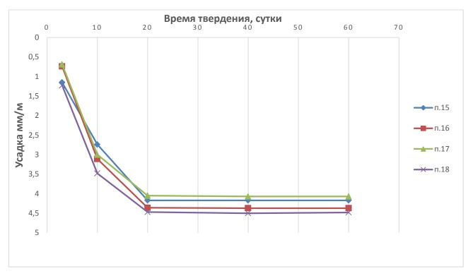
Рисунок 3.7— Усадочные деформации цементного камня в сочетании с суперпластификаторами
