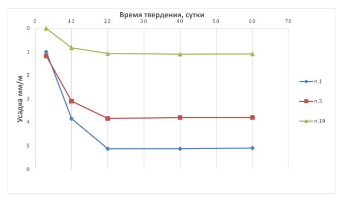
Рисунок 3.14 - Усадочные деформации
