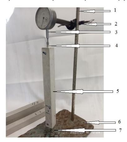
Рисунок 2.8 - Устройство для определения деформации усадки образцов 1 – стойка; 2-кронштейн; 3- индикатор; 4 – репер; 5 – образец; 6 – нижняя опора; 7 – конусообразный выступ;
