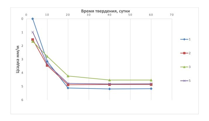
Рисунок 3.6— Усадочные деформации цементного камня в сочетании с суперпластификаторами
