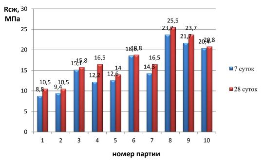
Рисунок 3.4 - Предел прочности образцов раствора на сжатие в зависимости от соотношения компонентов растворной смеси и вида суперпластификатора.
