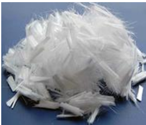
Рисунок 6 - Форма и текстура фибры, изготовленной из полипропилена [42]
