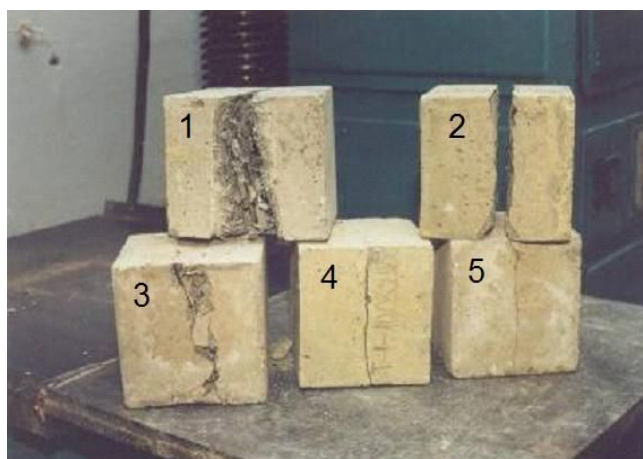
Рисунок 11 - Образцы – кубы из сталефибробетона после проведения испытаний на прочность на сжатие: 1 - с листовой фиброй, 2 - из бетона, 3 - фрезерованной, 4 - токарной и 5 - проволочной фиброй
