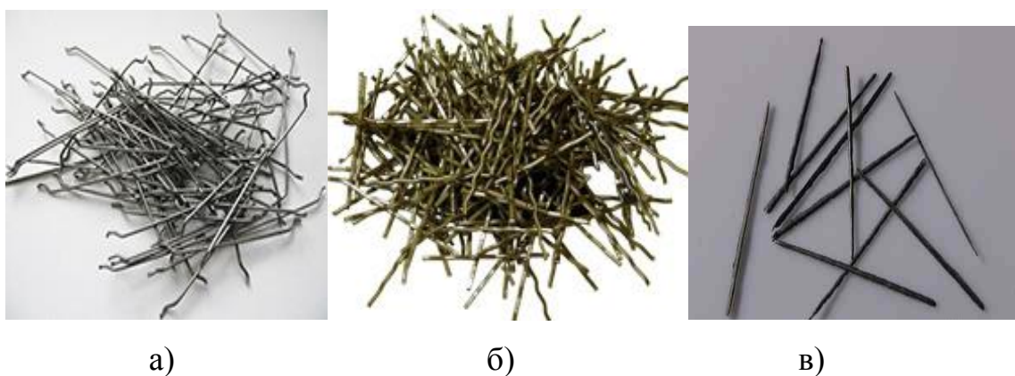
Рисунок 5 - Стальная фибра и ее виды
