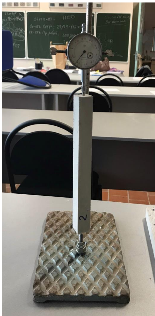
Рисунок 3.3 – Установка для измерения линейного расширения бетона
