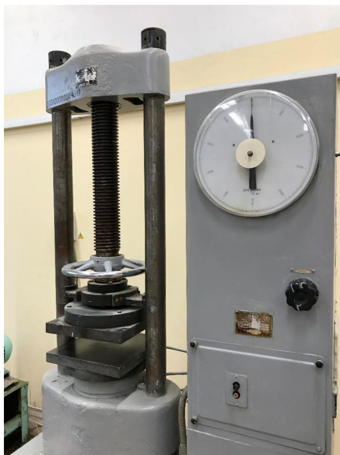
Рисунок 3.1 – Пресс для испытаний образца бетона на прочность при сжатии
