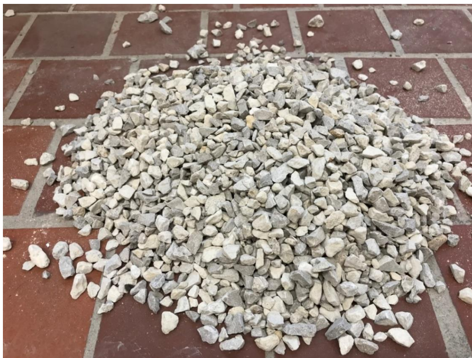
Рисунок 2.3 – Щебень с фракцией 5-10 мм
