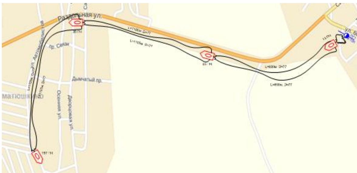
Рисунок 3.2 - Схема подачи воды в перекачку с использованием ПНС и АР
