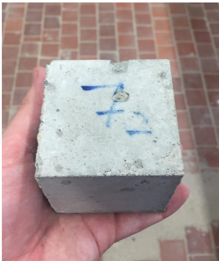
Рисунок 3.2 - Образец самоуплотняющегося бетона кубической формы с размерами ребра 70 мм
