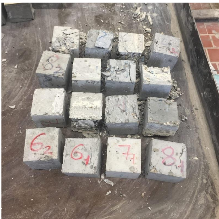
Рисунок 3.8 - Образцы самоуплотняющегося бетона после испытания на предел прочности при сжатии
