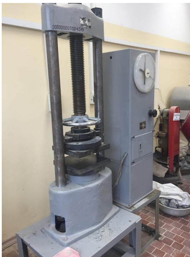
Рисунок 2.2 - Гидравлический пресс для определения прочности на сжатие образцов СУБ
