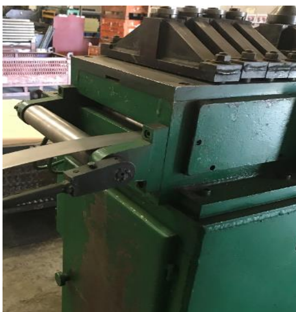
Рисунок 50 – Протяжка ленты через устройство
