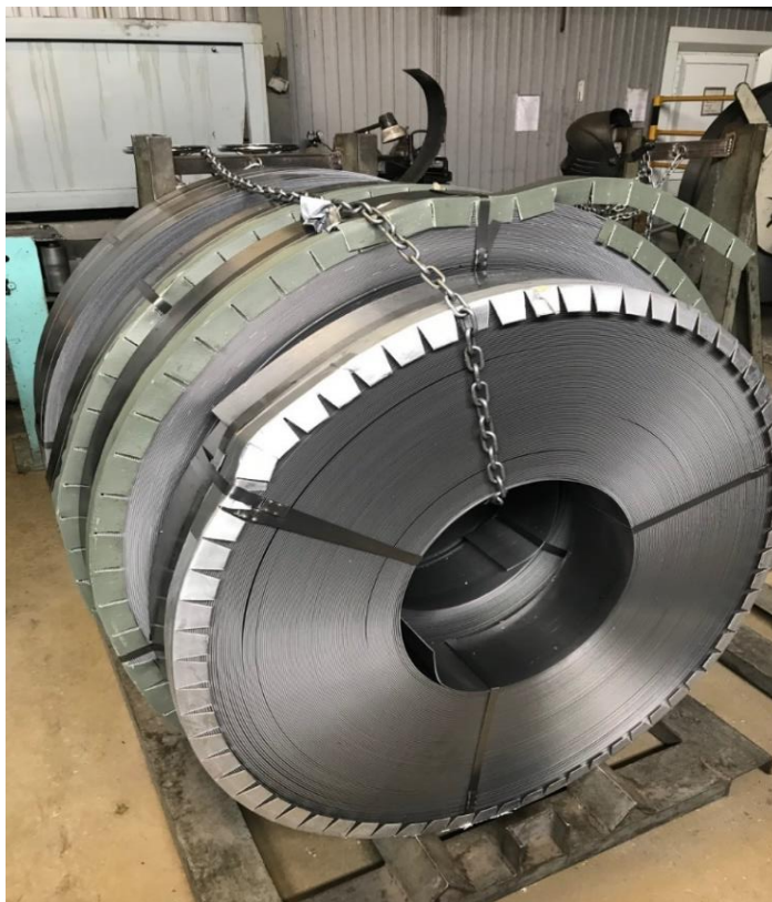
Рисунок 16 - Упакованная лента после промывки и обезжиривания
