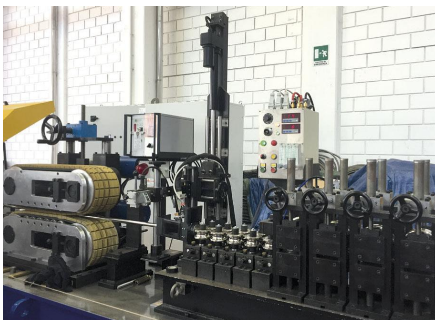
Рисунок 37 – Стан с неприводной формовочной секцией
