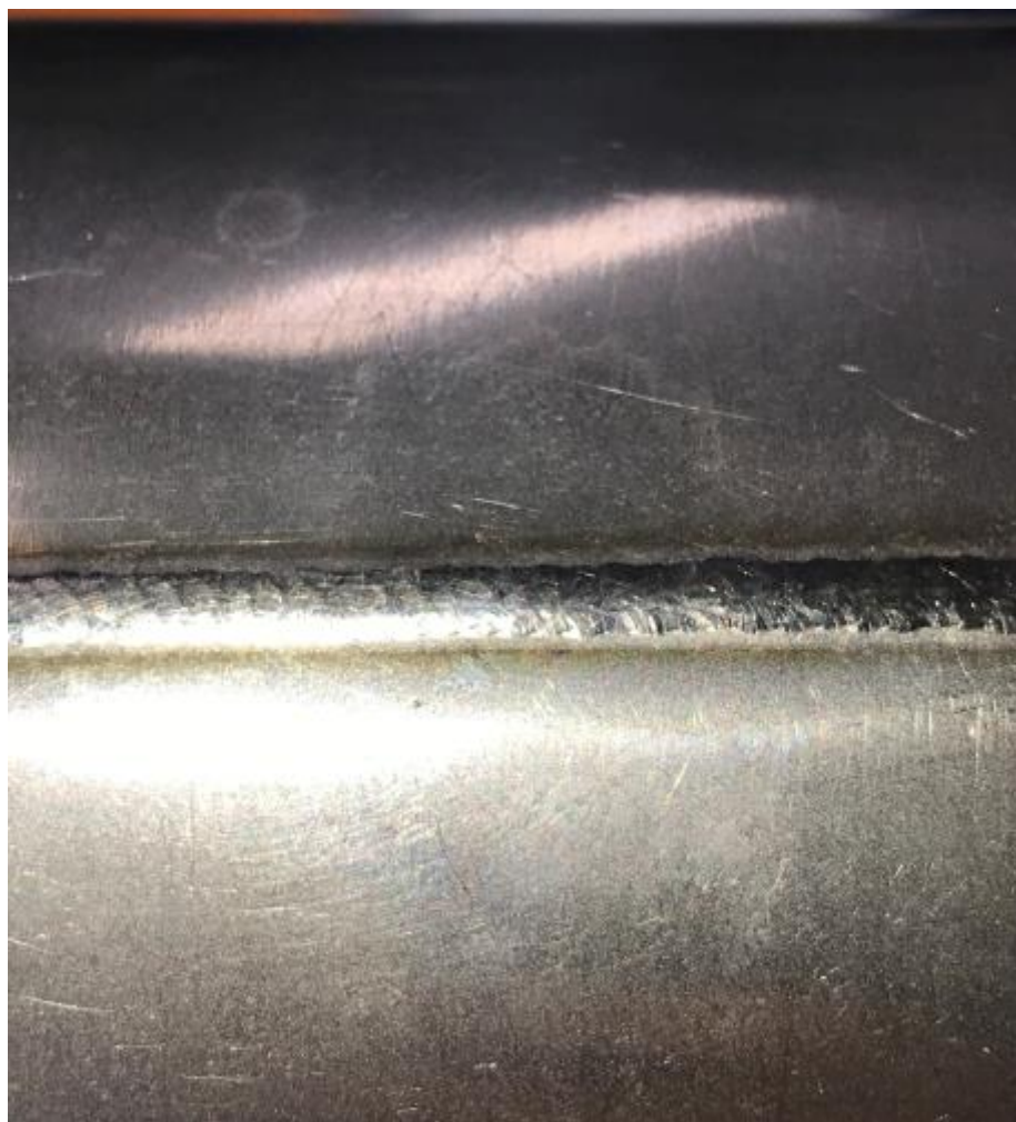
Рисунок 58 – Внешний вид корня шва трубы диаметром 55мм с толщиной стенок 0,12 мм
