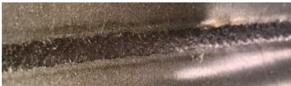
Рисунок 45 - Внешний вид сварного соединения при сварке импульсной дугой
