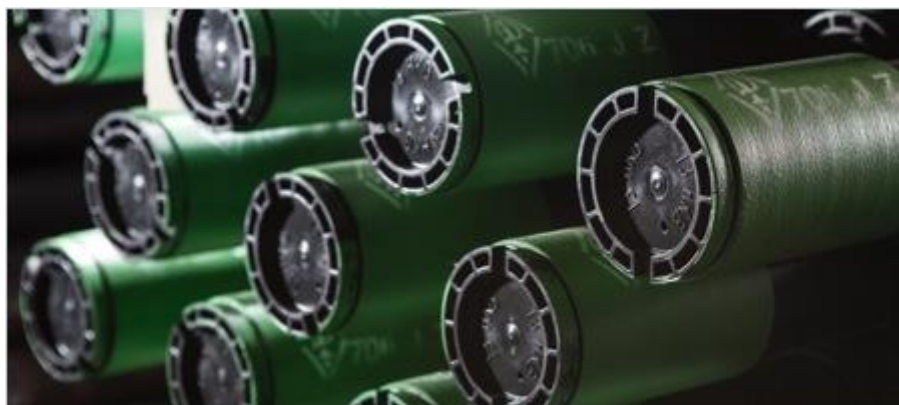
Рисунок 7 – Заглушки на торцах труб при упаковке
