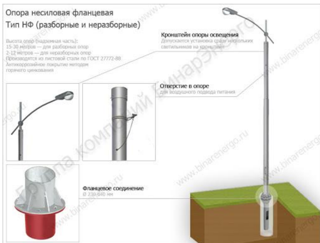
Рисунок 1.1 – Общий вид опоры освещения
