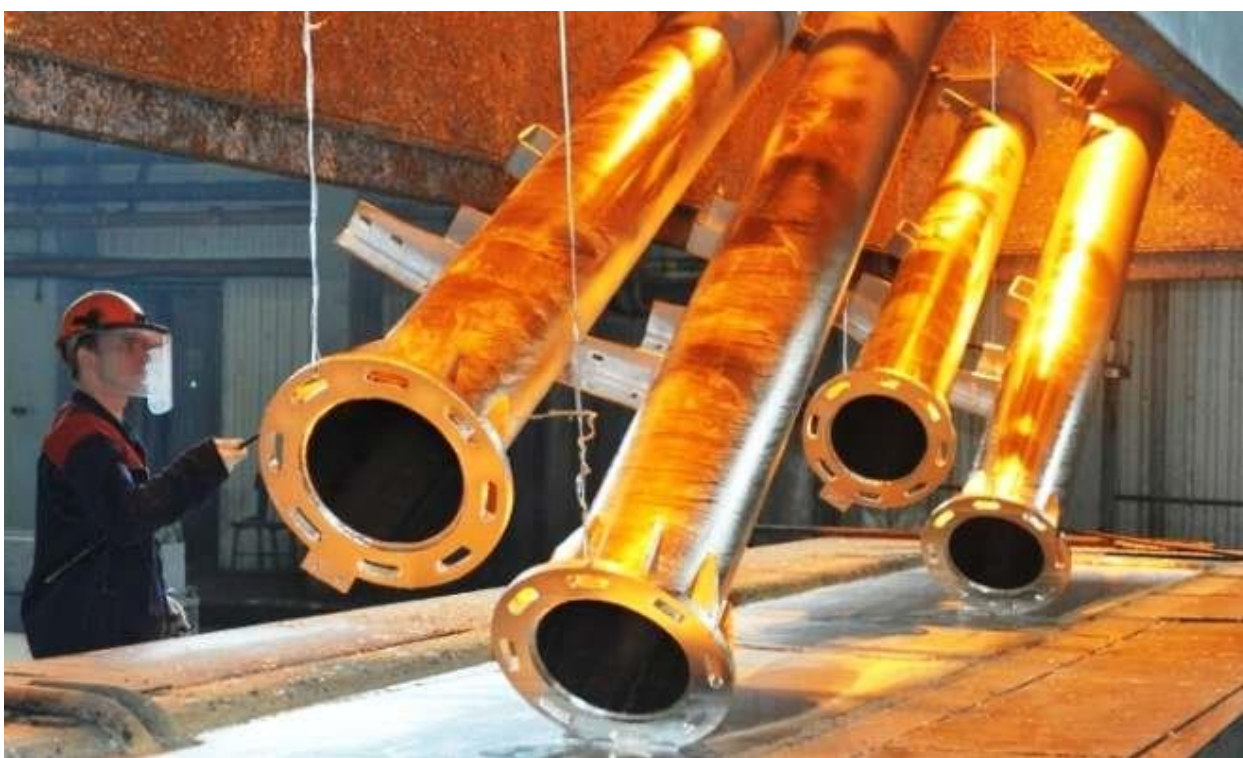
Рисунок 8.12 – Погружение опор в ванну с горячим цинком
