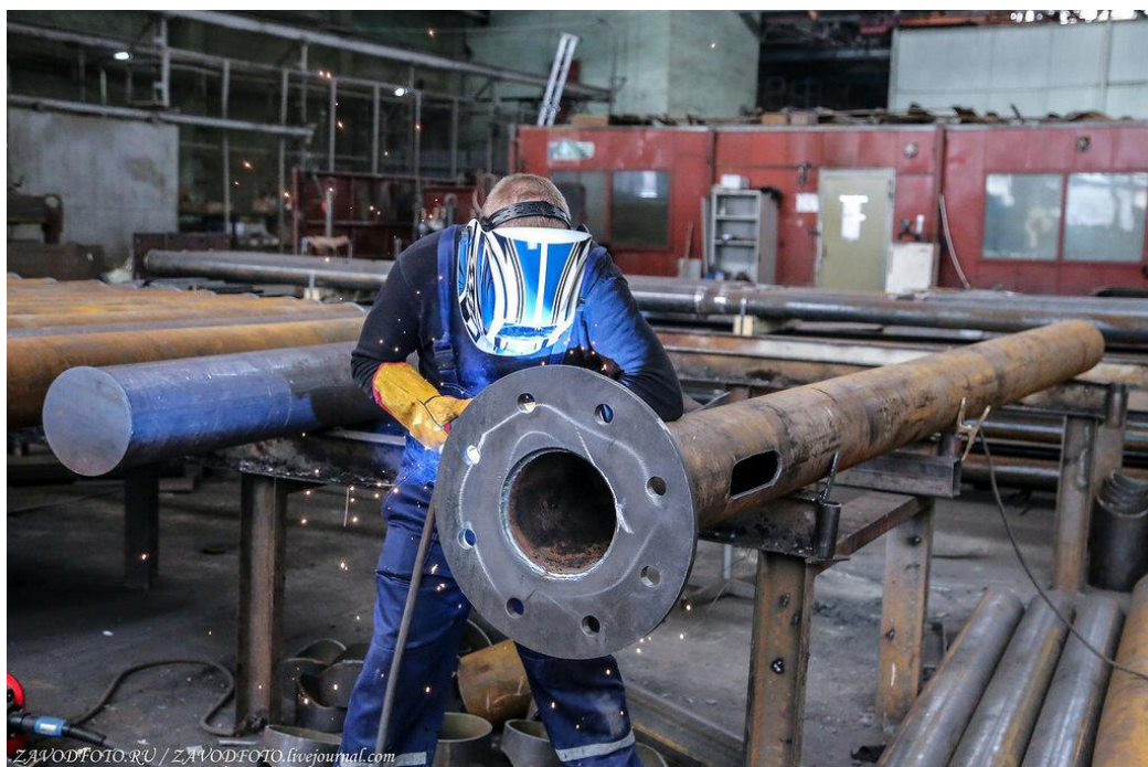
Рисунок 8.8 –Сварка плоского накидного фланца опоры освещения
