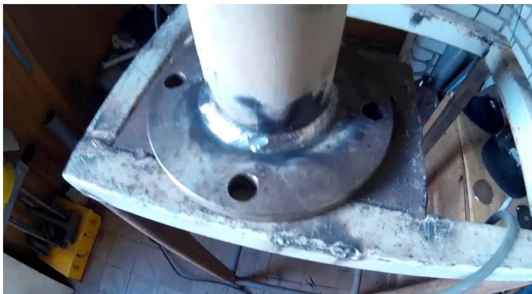
Рисунок 8.10 –Сварка трубы и плоского фланца (внешний шов)
