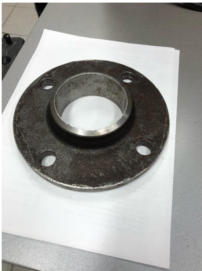
Рисунок 8.4 –Фланец воротниковый с v- образной обработкой кромки
