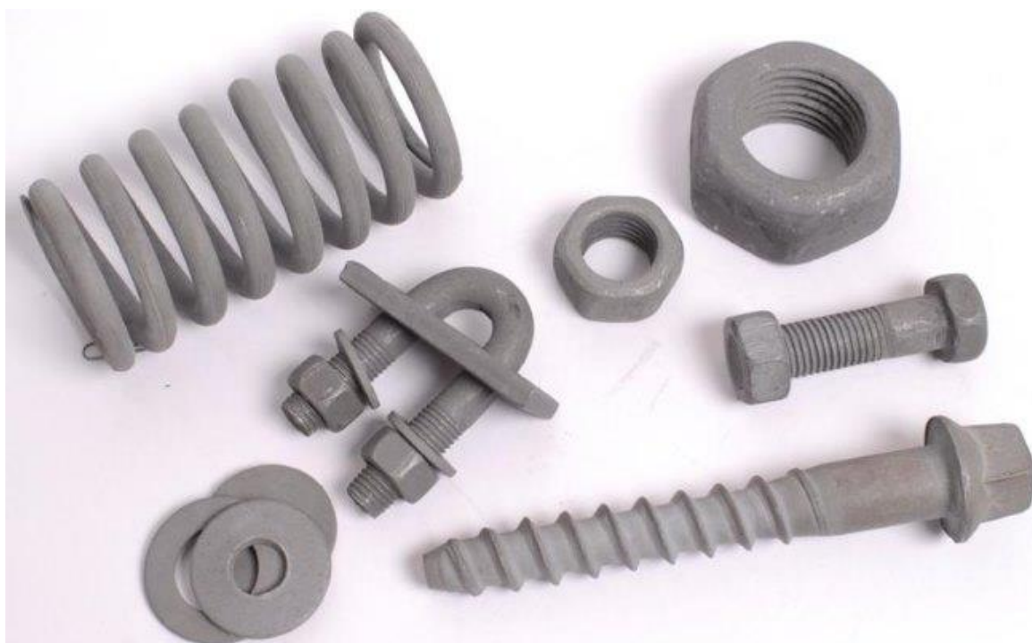
Рисунок 7.6 – изделия покрытые методом ТДЦ
