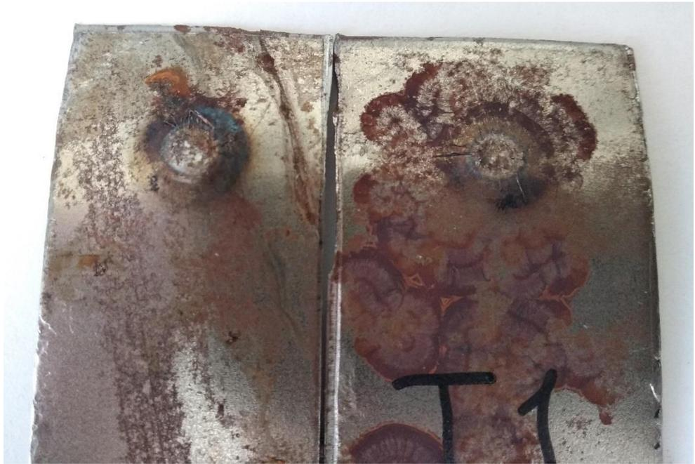
Рисунок 4.7в – Сварная точка образца Т1 после растяжения
