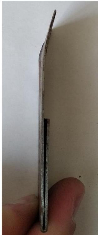
Рисунок 4.7г – Изгиб образца Т1 после испытания
