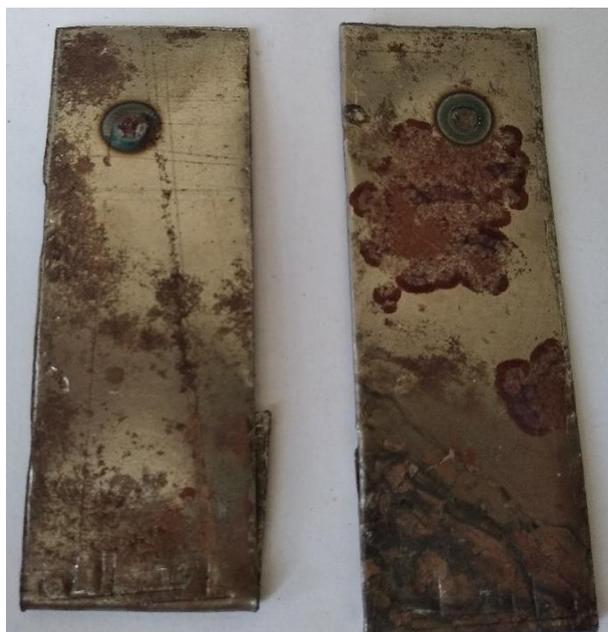
Рисунок 4.12б – Обратная сторона образцов после растяжения, сваренных при усиллии сжатия 200 кг
