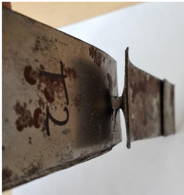
Рисунок 4.8в – Сварная точка образца T2 после растяжения
