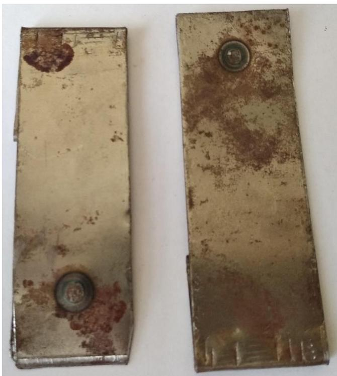
Рисунок 4.11б – Обратная сторона образцов после растяжения, сваренных при усилии сжатия 160 кг
