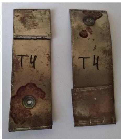
Рисунок 4.10а - Образцы после растяжения, сваренные при усилии сжатия 120 кг
