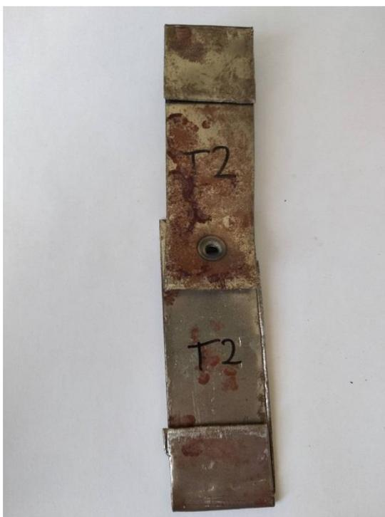
Рисунок 4.8а - Образцы после растяжения, сваренные при усилии сжатия 40 кг
