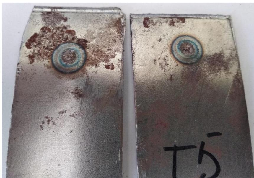
Рисунок 4.11в – Сварная точка образца T5 после растяжения
