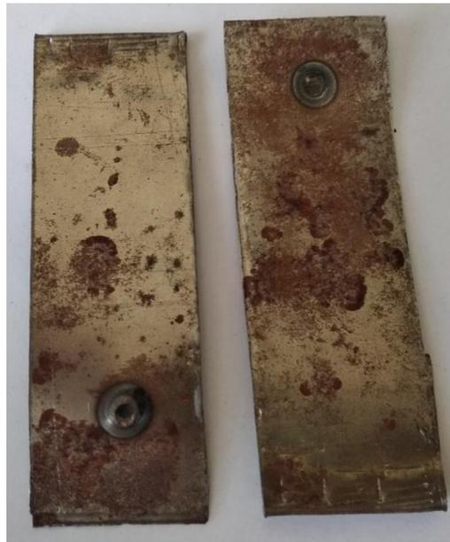
Рисунок 4.10б – Обратная сторона образцов после растяжения, сваренных при усилии сжатия 120 кг
