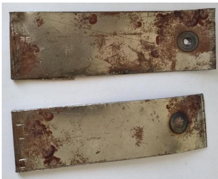
Рисунок 4.9б – Обратная сторона образцов после растяжения, сваренных при усилии сжатия 80 кг
