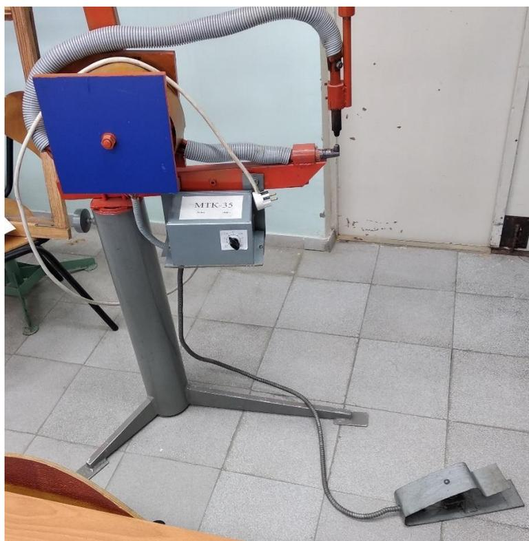
Рисунок 3.3 – Элементы управления сварочной машиной МТК-35
