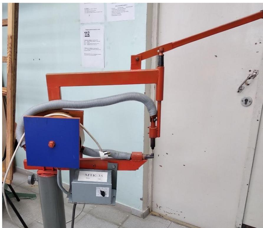
Рисунок 3.5 – Привод сжатия сварочной машины МТК-35
