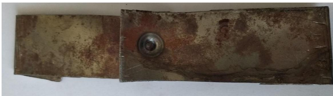
Рисунок 4.13б – Обратная сторона образцов после растяжения, сваренных при усилии сжатия около 0 кг
