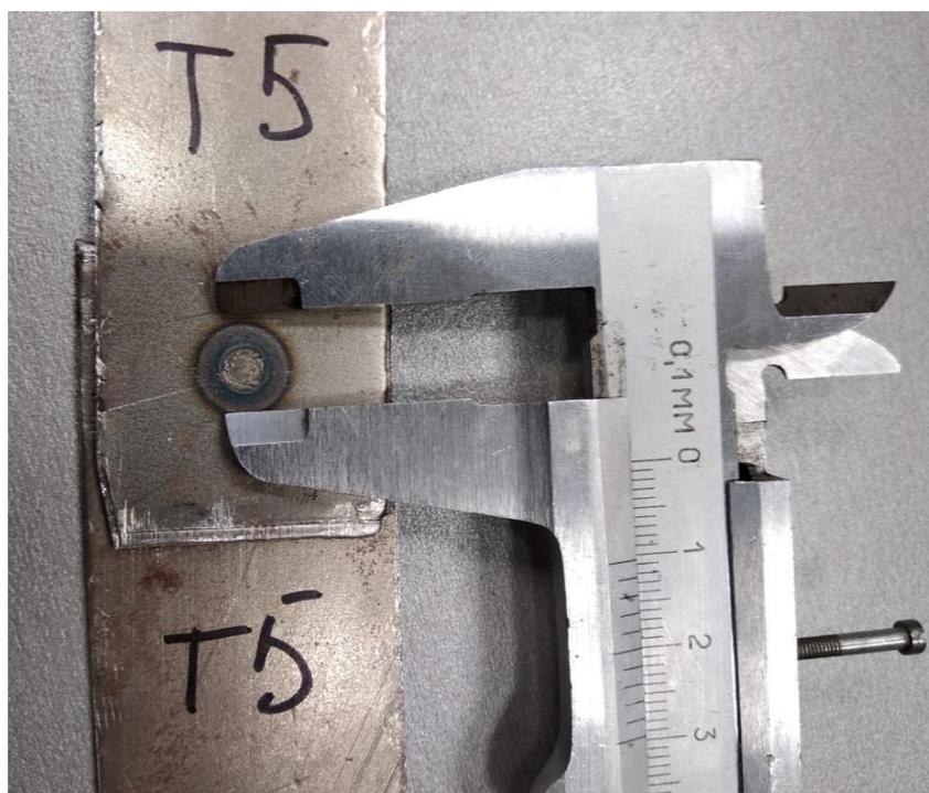
Рисунок 4.2 – Измерение размеров ЗТВ
