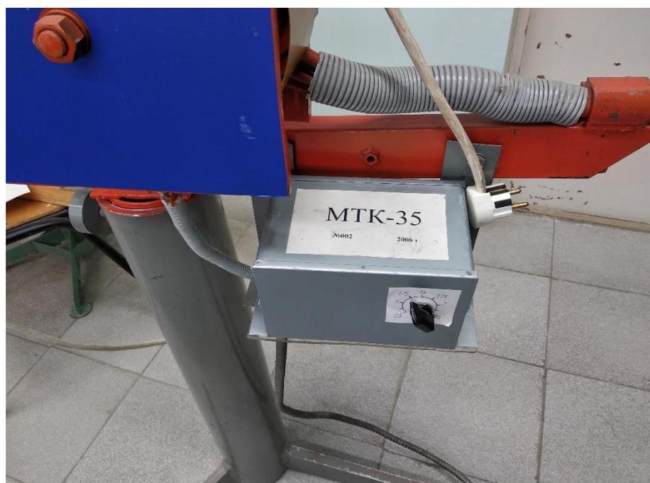
Рисунок 3.4 – Блок управления временем сварки
