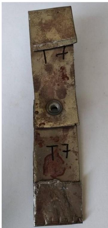
Рисунок 4.13а - Образцы после растяжения, сваренные при усилии сжатия около 0 кг
