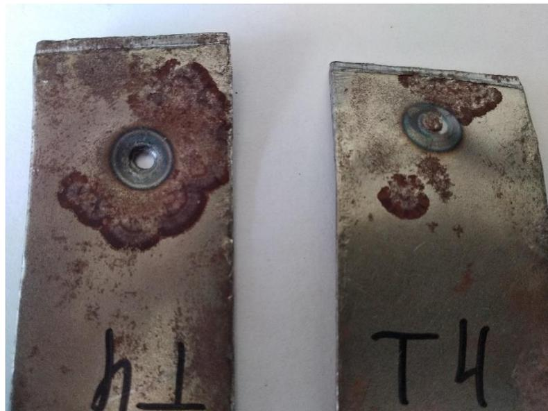
Рисунок 4.10в – Сварная точка образца T4 после растяжения
