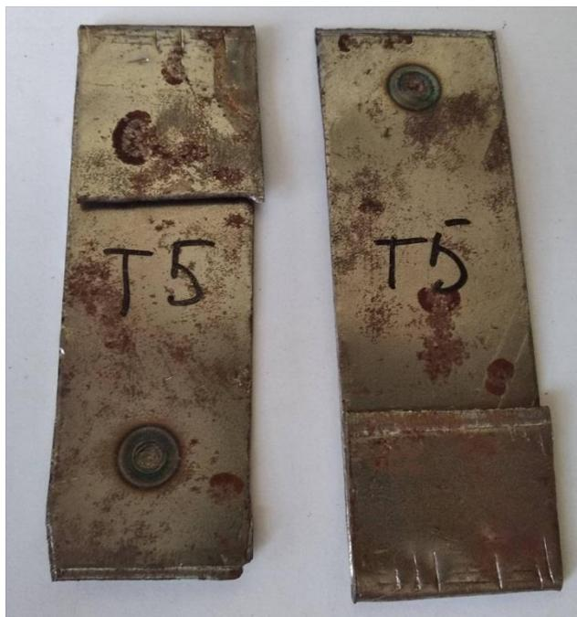
Рисунок 4.11а - Образцы после растяжения, сваренные при усилии сжатия 160 кг
