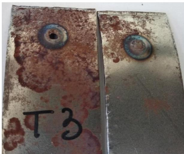
Рисунок 4.9в – Сварная точка образца ТЗ после растяжения
