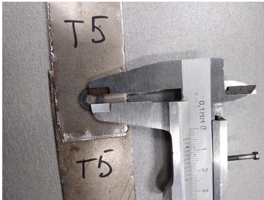
Рисунок 4.1 - Измерение размеров сварной точки
