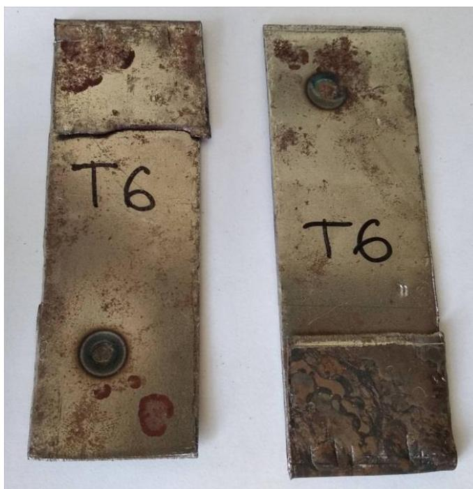
Рисунок 4.12а - Образцы после растяжения, сваренные при усилии сжатия 200 кг
