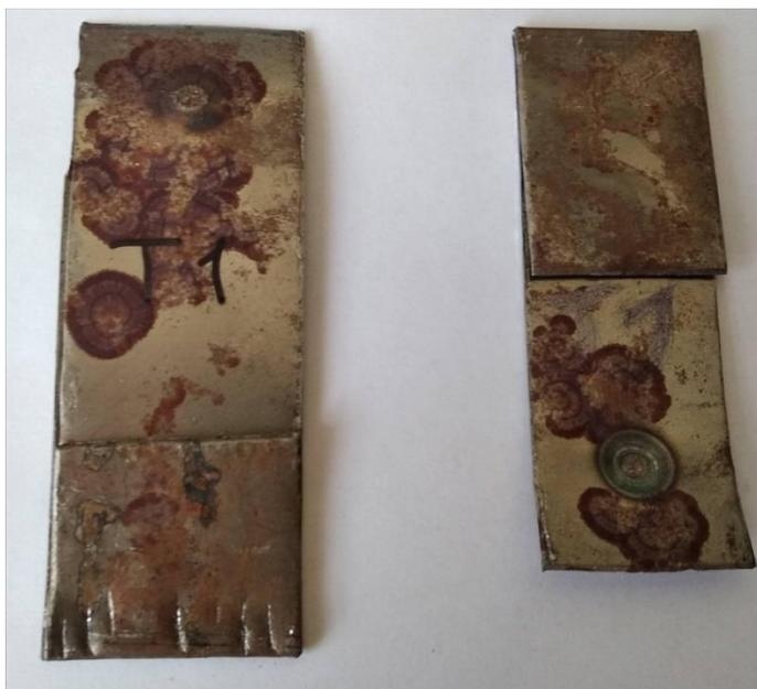
Рисунок 4.7а - Образцы после растяжения, сваренные при усилии сжатия 20 кг
