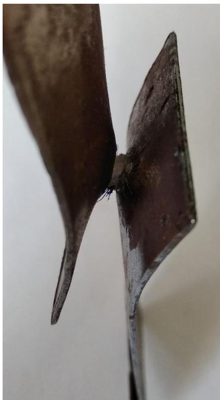
Рисунок 4.13в – Сварная точка образца Т7 после растяжения
