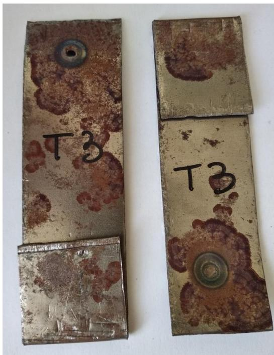
Рисунок 4.9а - Образцы после растяжения, сваренные при усилии сжатия 80 кг
