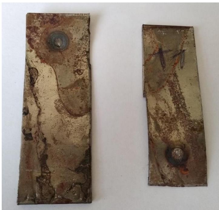
Рисунок 4.7б – Обратная сторона образцов после растяжения, сваренные при усилии сжатия 20 кг
