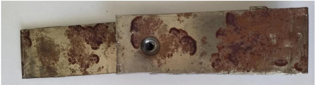
Рисунок 4.8б – Обратная сторона образцов после растяжения, сваренных при усилии сжатия 40 кг
