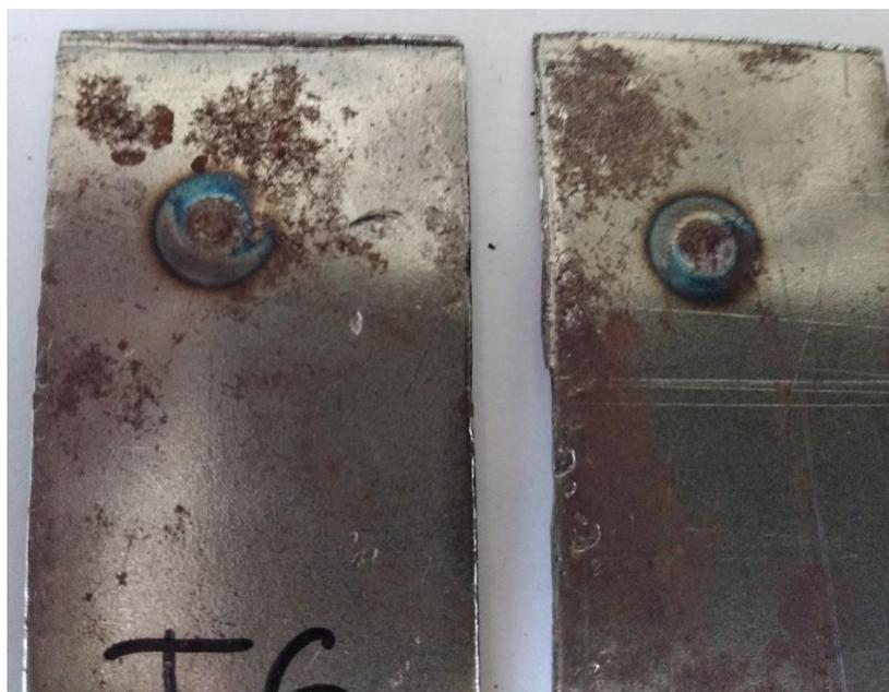
Рисунок 4.12в – Сварная точка образца Т6 после растяжения
