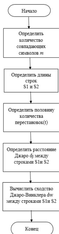
Рисунок 3 – Блок-схема алгоритма Джаро-Винклера
