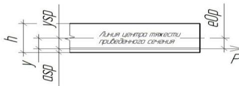
Рисунок 2.2.2 – Схема усилий предварительного напряжения арматуры в поперечном направлении железобетонного элемента
