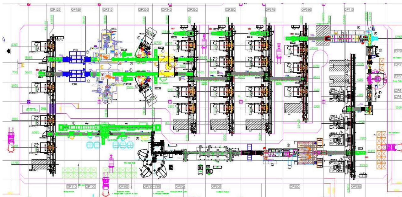
Рисунок 10 - Планировка сборочной линии коробки перемены передач KJ-004
