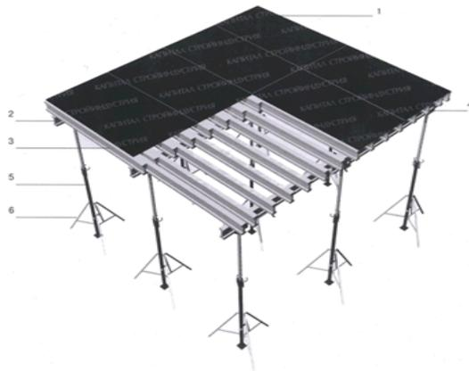
1 - палуба; 2 - продольная балка; 3 - поперечная балка; 4 – вилка универсальная; 5 - стойка опорная телескопическая; 6 – тренога
