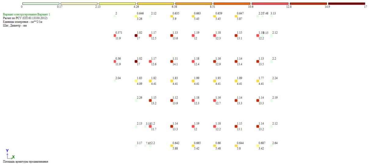
Рисунок 2.2 - Площадь поперечной арматуры продавливания и коэффициент запаса
