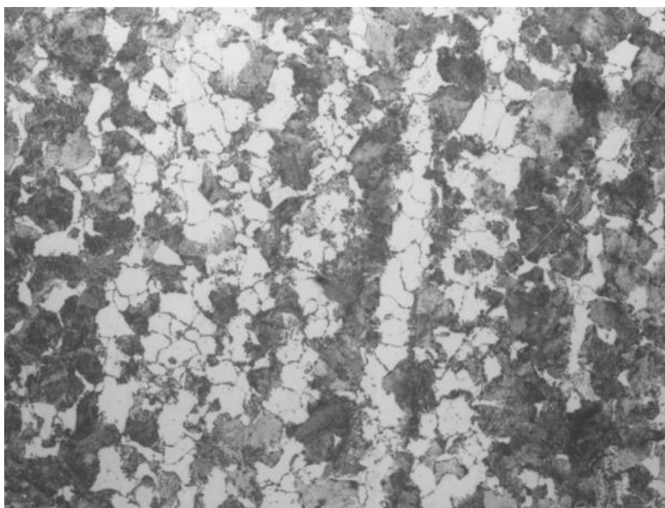
Рисунок 23 – Температура закалки - 750^{\circ}\text{C} , предварительная термообработка – нормализация 840^{\circ}\text{C} , 15 мин, микроструктура: мартенсит, феррит, X500
