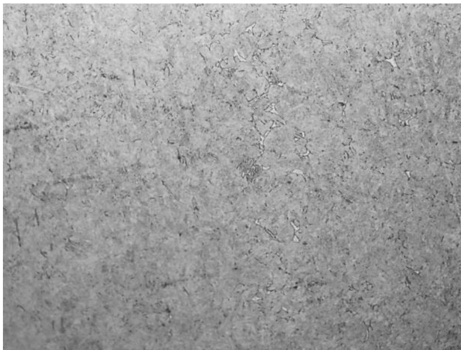
Рисунок 25 – Температура - 760° С, предварительная термообработка – отжиг 840° С, 15 мин, охлаждение с печью до температуры - 630° С, микроструктура: мартенсит, следы феррита, троостит, X500
