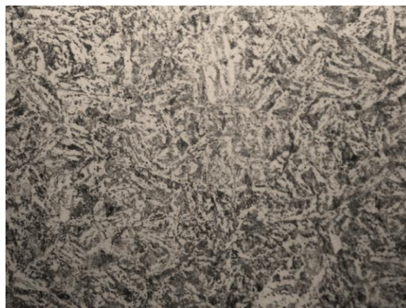
б) Поперечное сечение. Троостосорбит, бейнит, феррит, твердость 271 HV5, X500
