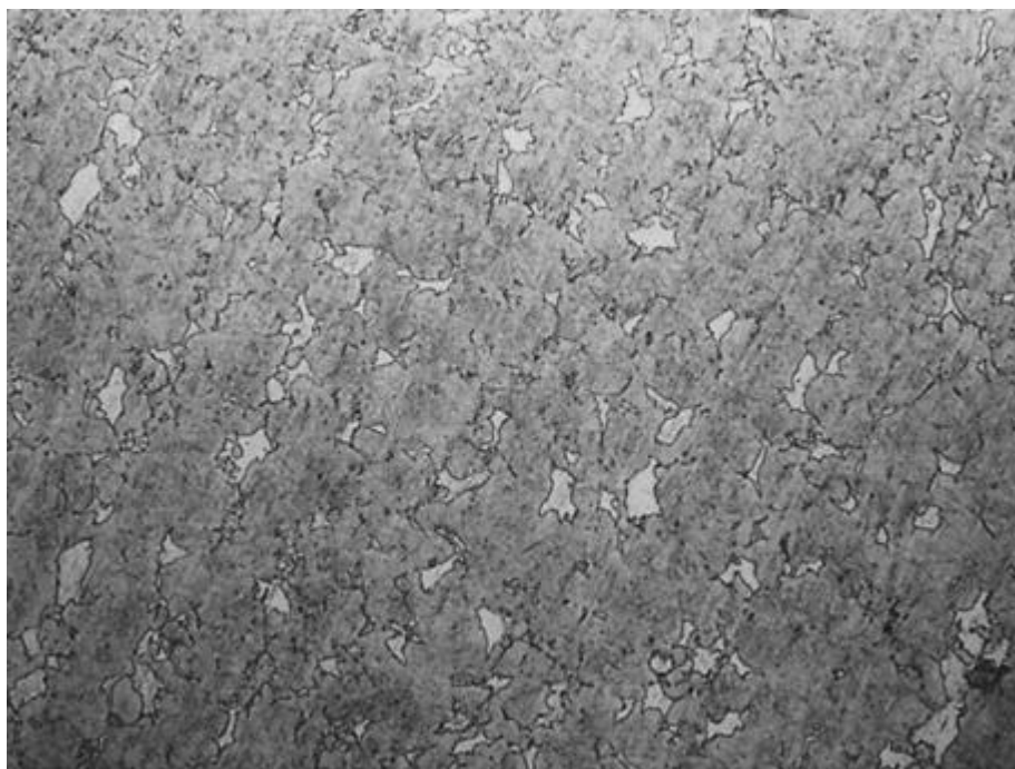
Рисунок 23 – Температура закалки - 750^{\circ}\text{C} , предварительная термообработка – нормализация 840^{\circ}\text{C} , 15 мин, микроструктура: мартенсит, феррит, X500
