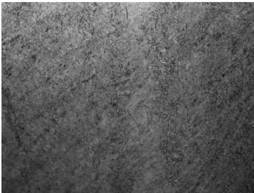
Рисунок 21 – Нормализация, температура нагрева - 840° C, 15 мин, охлаждение на воздухе, твердость 307 HV5, X500
