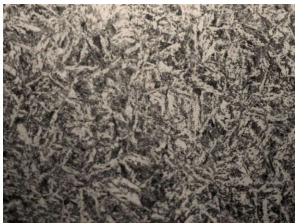
а) Продольное сечение. Троостосорбит, бейнит, феррит, твердость 280 HV5, X500
