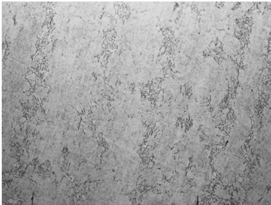
Рисунок 26 – Температура - 750° С, предварительная термообработка – отжиг 840° С, 15 мин, охлаждение с печью до температуры - 630° С, микроструктура: мартенсит, троостит, следы феррита, X500
