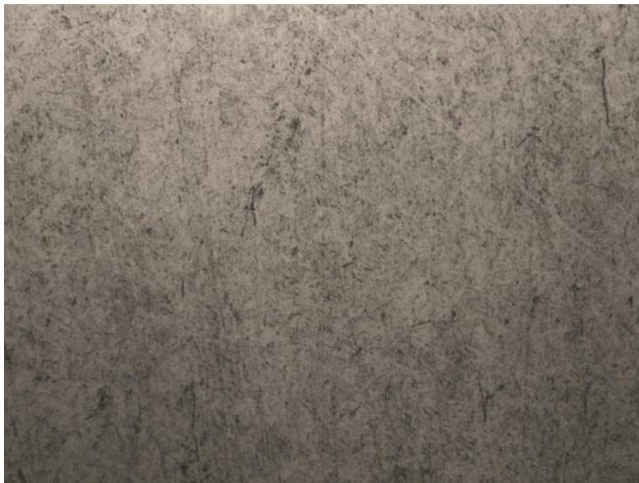
Рисунок 16 - Температура - 800° С, твердость 570 HV5 X500
