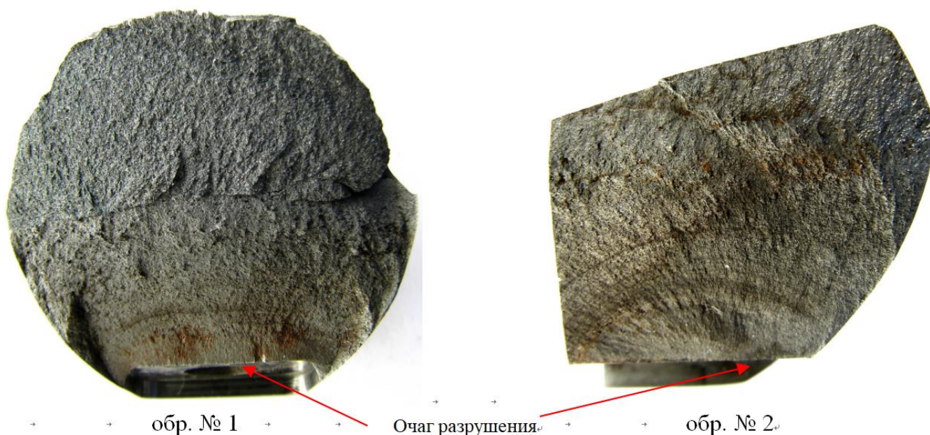
Рисунок 8 - Внешний вид поверхности разрушения пуансонодержателей
