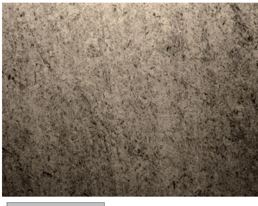
Рисунок 15 - Температура - 840° С, твердость 583 HV5 X500
