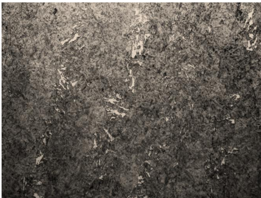
Рисунок 18 - Температура - 760° С, твердость 534 HV5 X500
