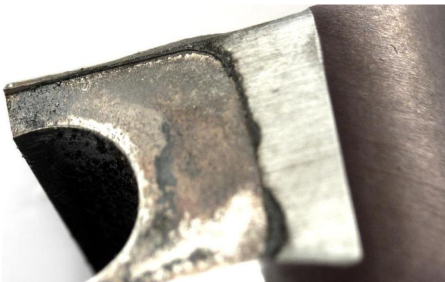
Рисунок 10 - Посадочное место детали №2, край совпадает с очагом разрушения
