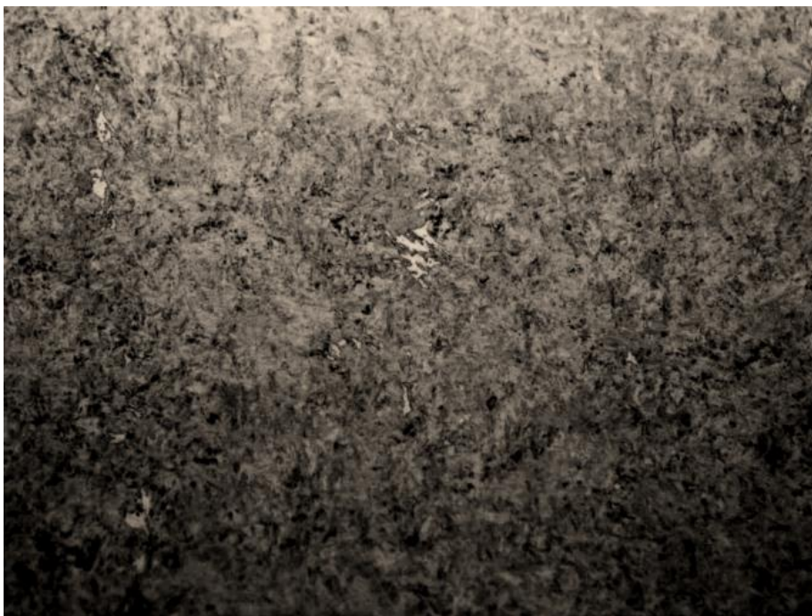
Рисунок 16 - Температура - 800° С, твердость 570 HV5 X500
