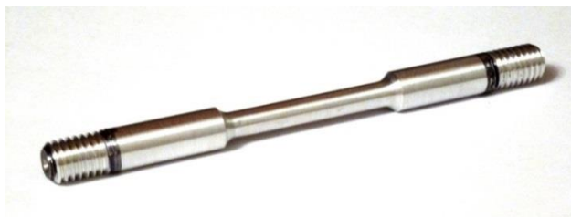
Рисунок 2.2 – Образец из сплава ВТ8М-1 для испытаний на растяжение
