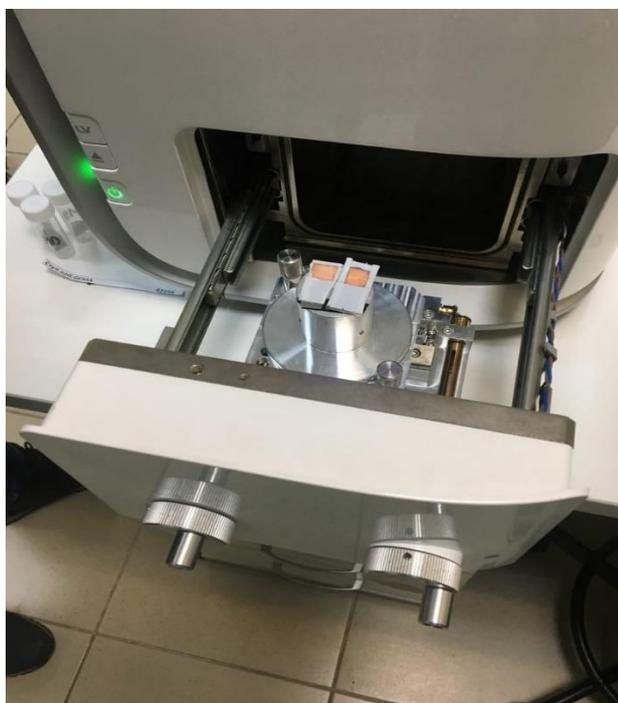
Рисунок 18 – Предметный столик вакуумной камеры прибора
