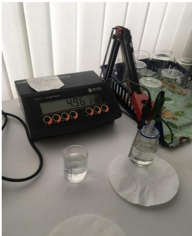
Рисунок 13 - pH- метр HI 2211 pH/ORP Meter фирмы HANNAinstruments
