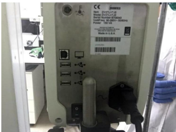
Рисунок 8 – Задняя панель вискозиметра с кнопкой включения прибора
