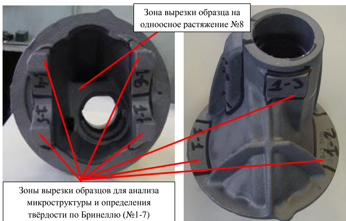
Рисунок 5 – Характерные зоны для исследования детали «Картер редуктора заднего моста»
