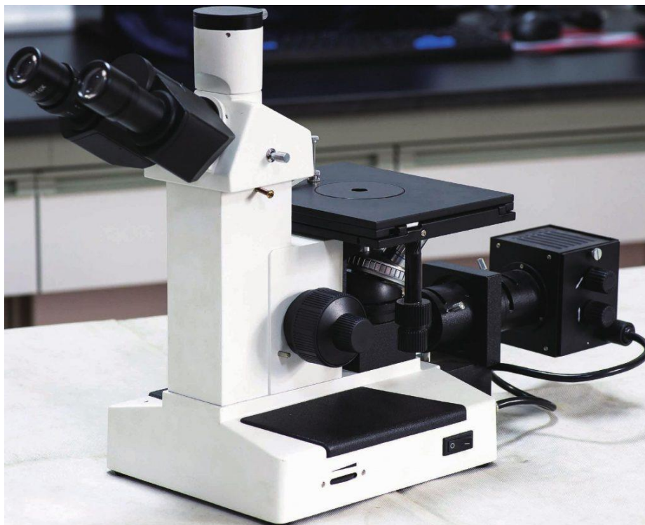
Рисунок 10 – Световой металлографический микроскоп UNIMET 8585
