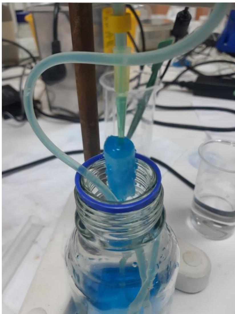
Рисунок 3.10 - процесс сорбции метиленовый синий
