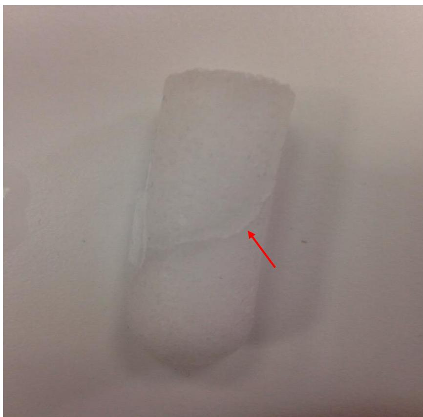
Рисунок 3.5 - повреждённый образец при извлечении, стрелкой указано место пореза
