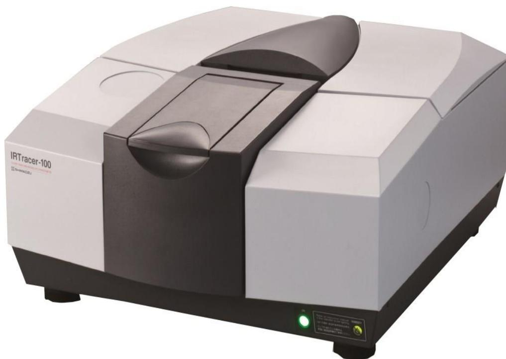
Рисунок 2.11- Спектрометр IRTraker-100 ИК-Фурье
