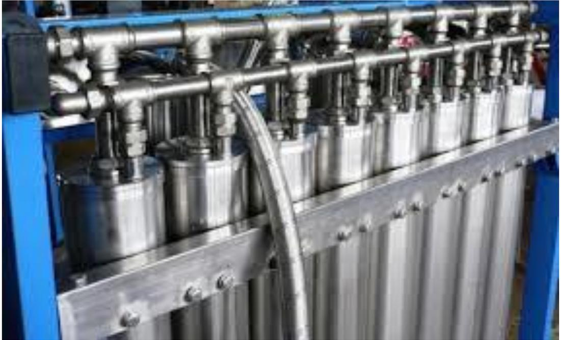
Рисунок 1.6 – Пример установки с керамическими мембранами
