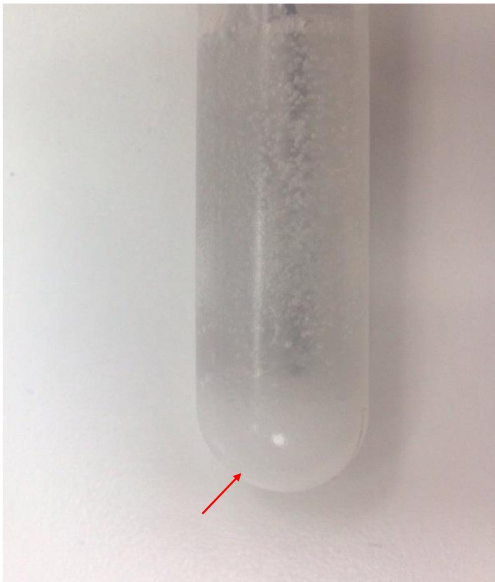
Рисунок 3.2 – Осадок твёрдых примесей на дне полученного образца
