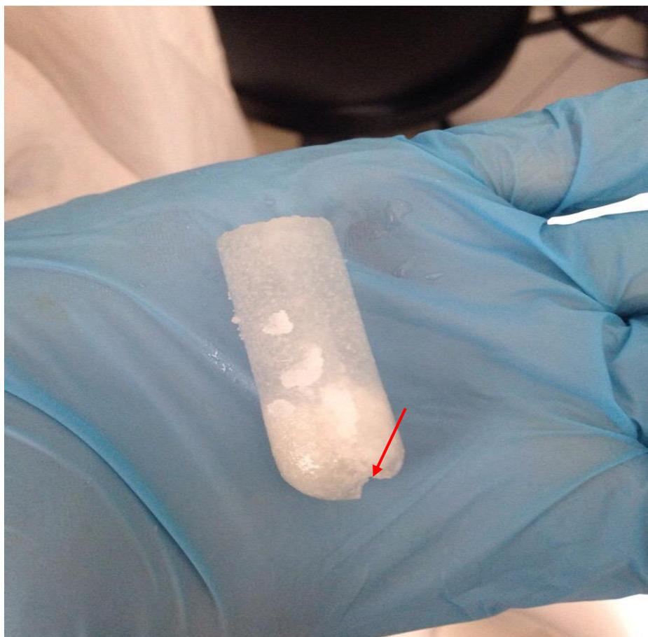
Рисунок 3.4 – повреждённый образец при извлечении, стрелкой указано место отрыва
