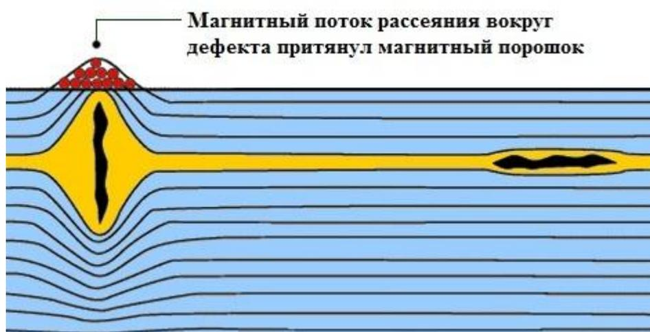
Рисунок 2 – Скапливание порошка на месте дефекта.
