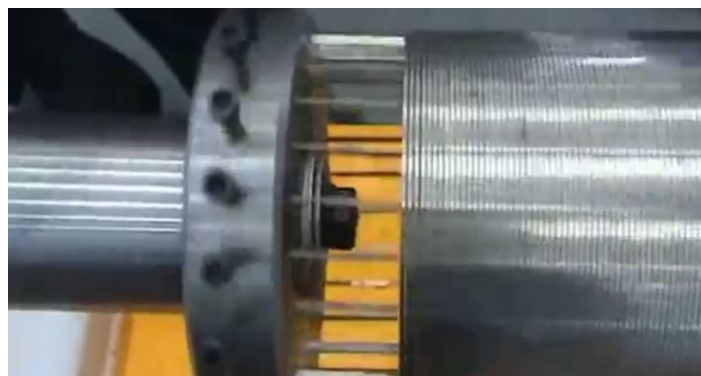
Рисунок 2.1 – Навивка проволоки на каркас на станке
