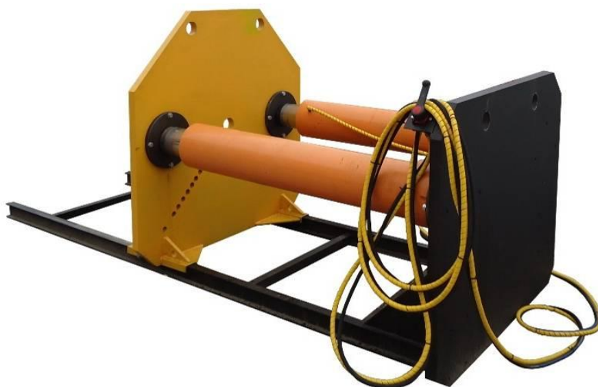
Рисунок 3.12 – Машина для бестраншейной прокладки
