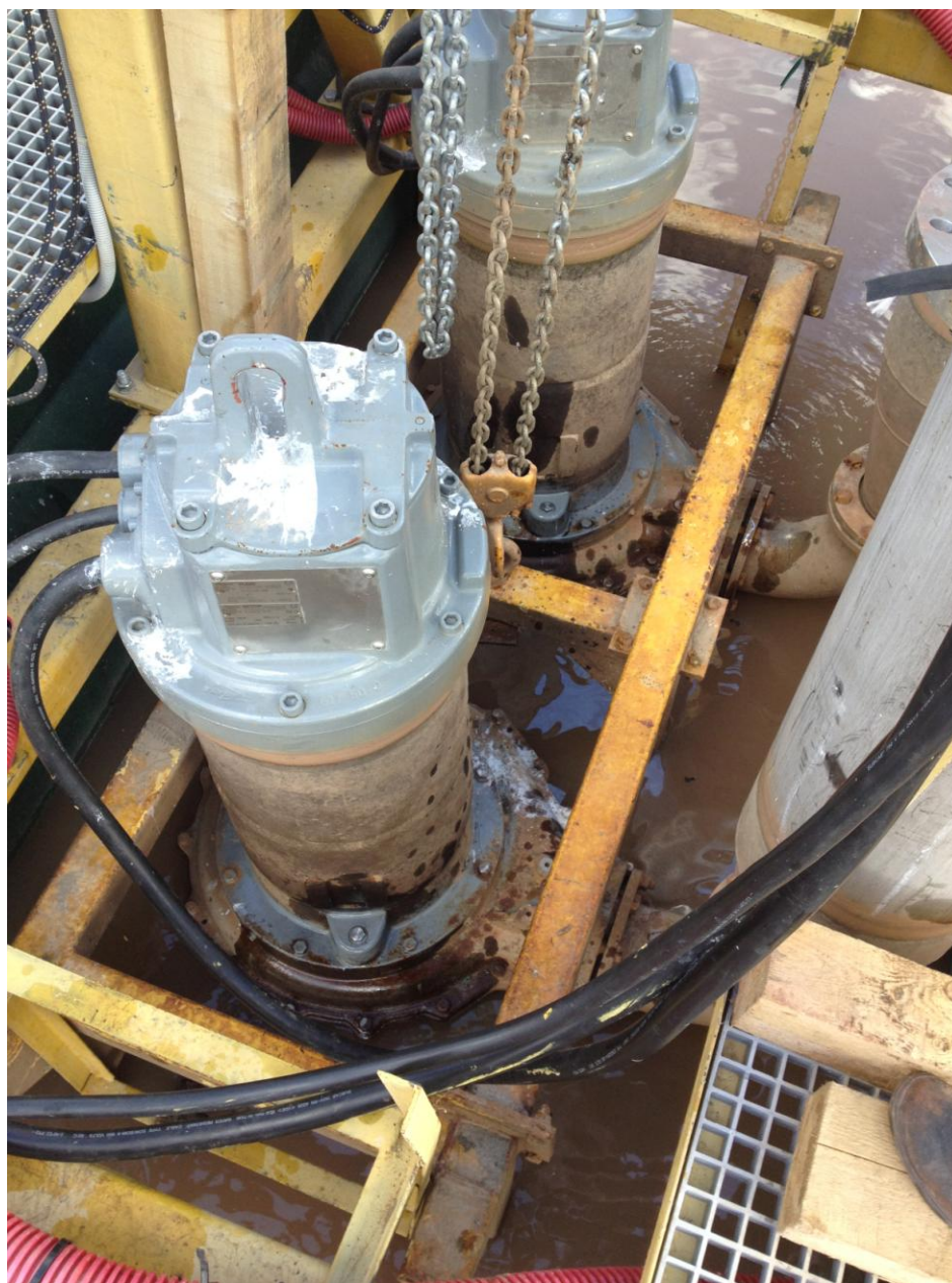
Рисунок 3.11 – Шламовый насос Flygt HS 5570/705, 125 кВт
