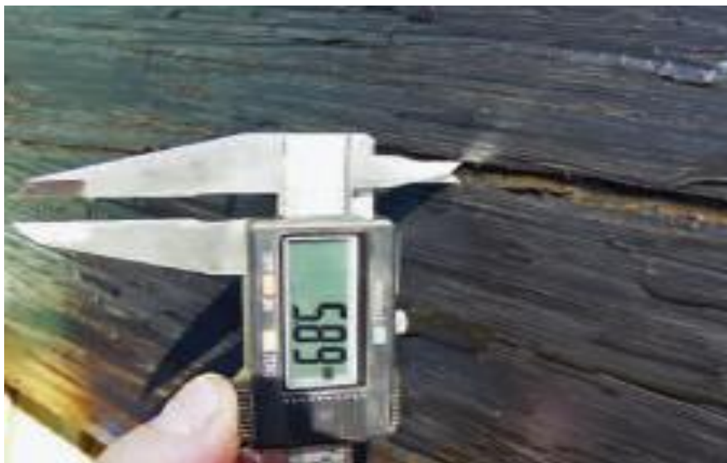
Рисунок №36 Замер ширины царапин после протяжки
