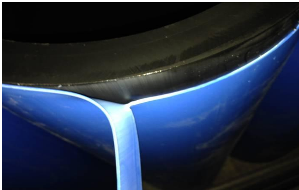
Рисунок №40 Строение полиэтиленовой трубы с защитной оболочкой
