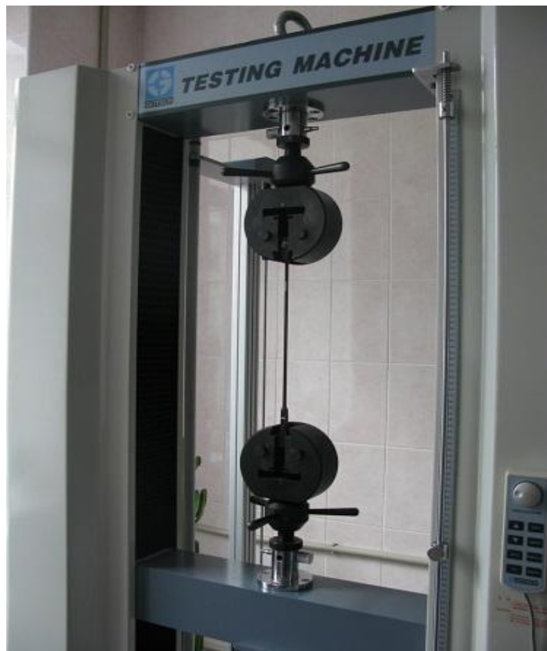
Рисунок №27 Машина для теста на растяжение
