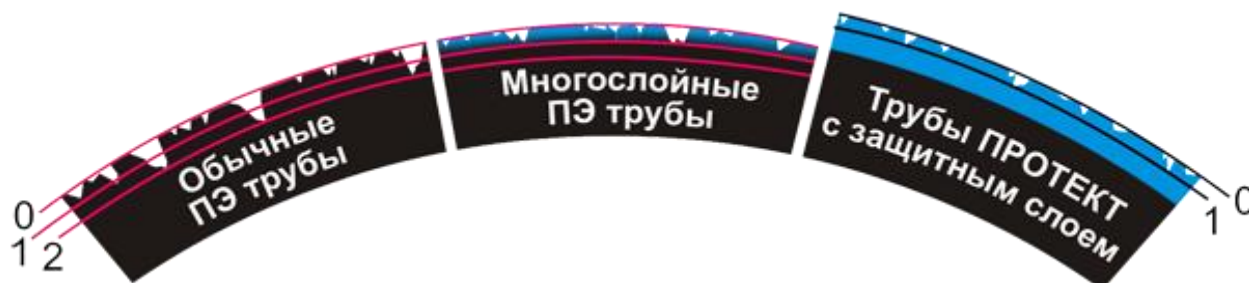
Рисунок №25 Характер механических повреждений различных типов ПЭ труб, возникающих при протяжке бестраншейными методами
