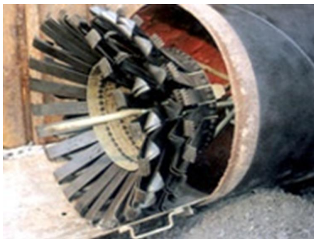
Рисунок №17 Скребок для механической прочистки
