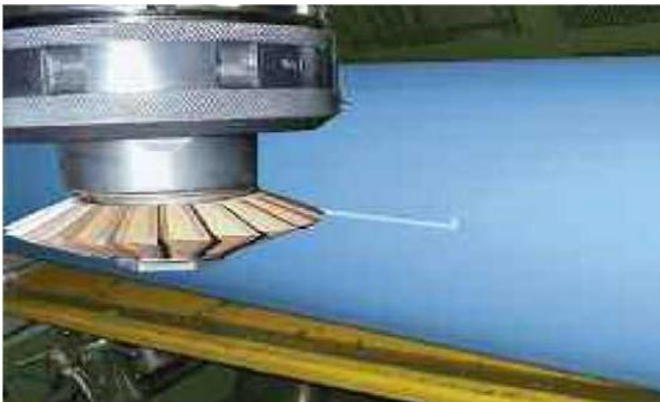
Рисунок №32 Лабораторные испытания определения стойкости защитного покрытия к механическим повреждениям методом царапания.
