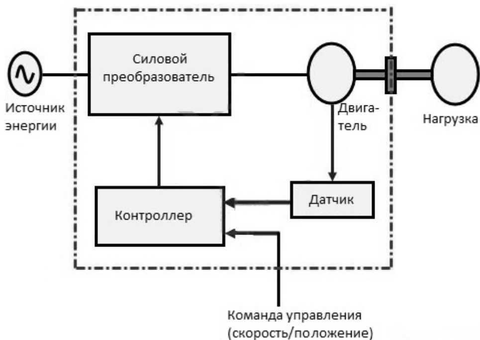
Рисунок 1- Типичная схема привода
