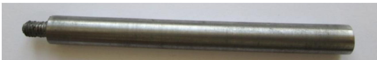
Рисунок 1.6 – Чистый купон, без следов СРБ
