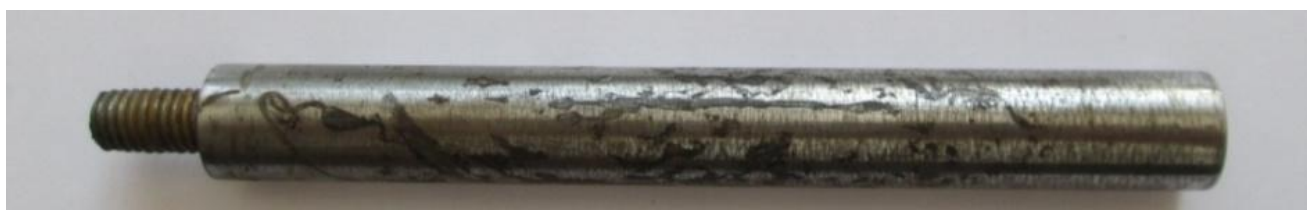
Рисунок 1.5 – Стальные купоны (Сталь 20) с явным покрытием сульфатредуцирующими бактериями (СРБ)
