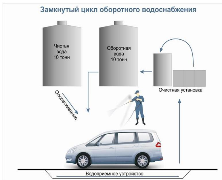
Рисунок 5– Замкнутый водооборотный цикл
