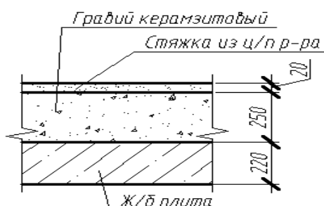
Рисунок 1.2 – Конструкция чердачного перекрытия
