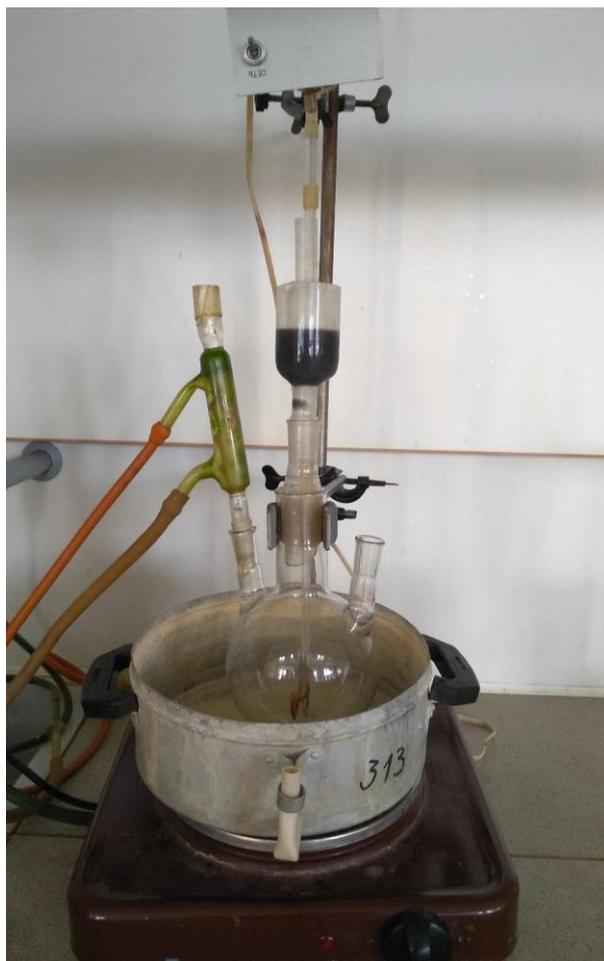
Рисунок 5 – Лабораторная установка получения смолы
