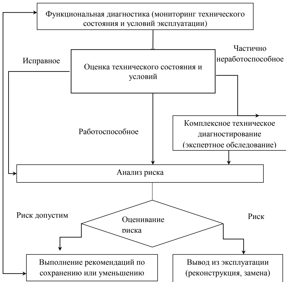
Рисунок 7 - Проведение технического диагностирования объектов газораспределительных сетей
