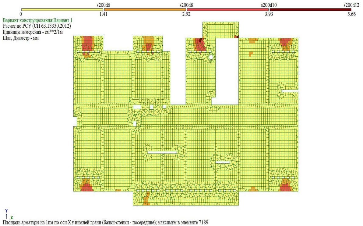
Рисунок 5.12 - Плита перекрытия 3 этажа. Нижнее армирование по X.
