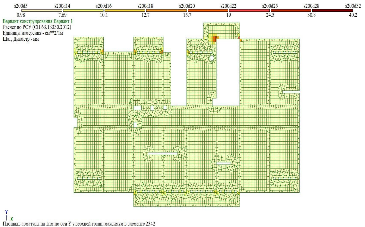
Рисунок 5.15 - Плита перекрытия 3 этажа. Верхнее армирование по Y.
