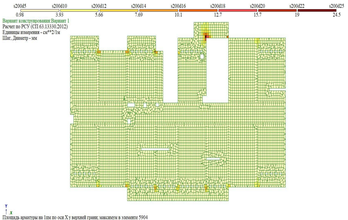
Рисунок 5.13 - Плита перекрытия 3 этажа. Верхнее армирование по X.
