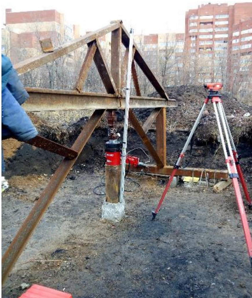
Рисунок В.24 – Испытание буровой сваи статической вдавливающей нагрузкой после усиления упорной фермы
