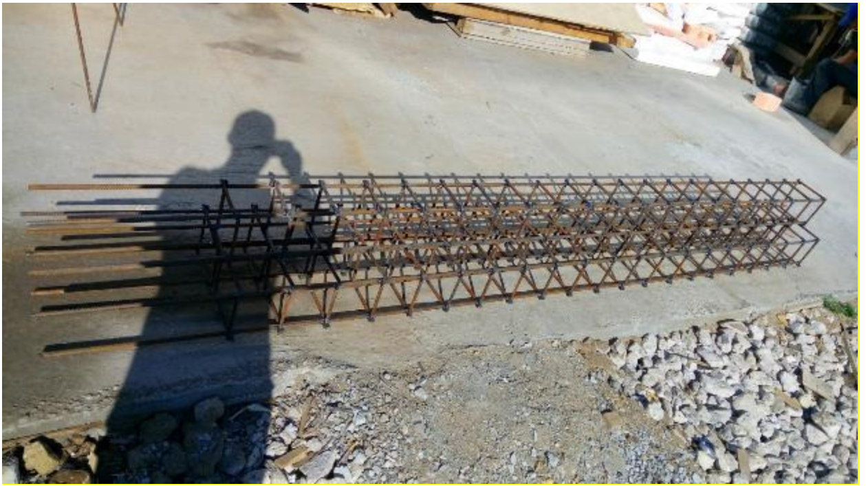
Рисунок В.3 – Каркасы испытываемых свай
