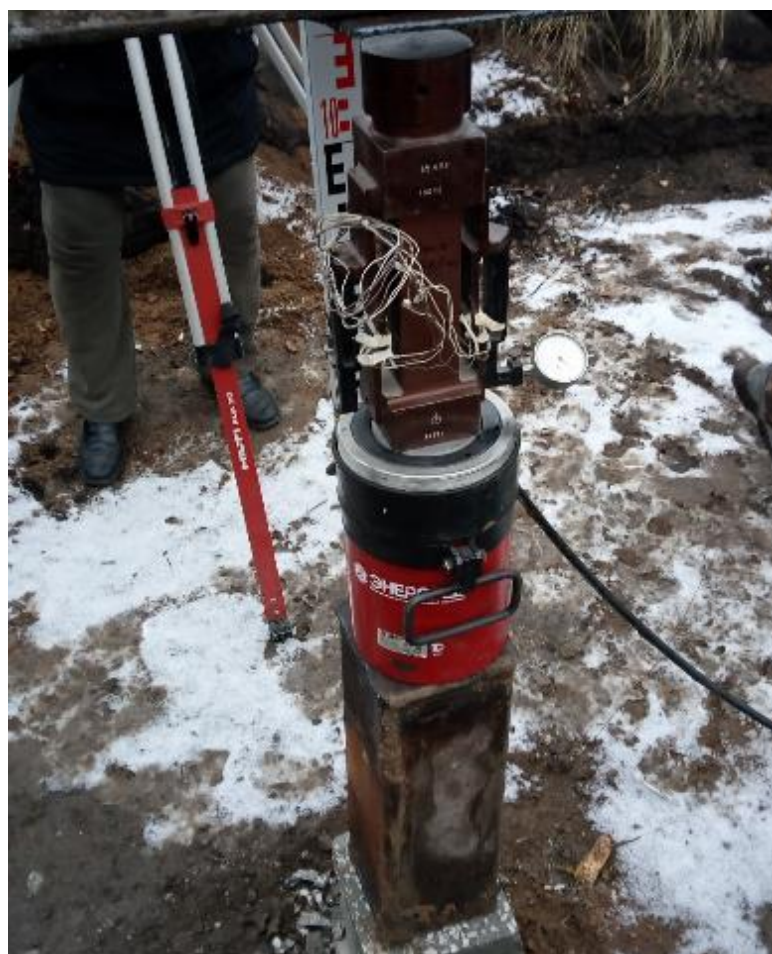
Рисунок В.22 – Домкрат ДП20П50, динамометр ДОС-100 и метал. стойка
