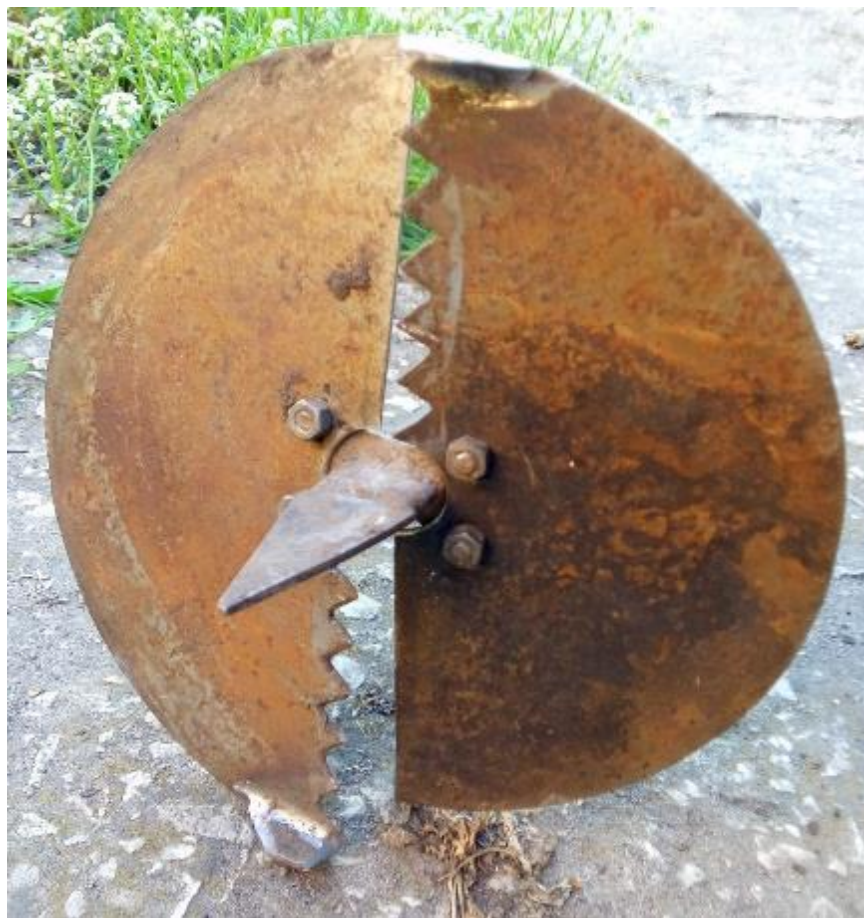
Рисунок В.4 – Изготовленные лопасти ручного бура для бурения испытываемой сваи
