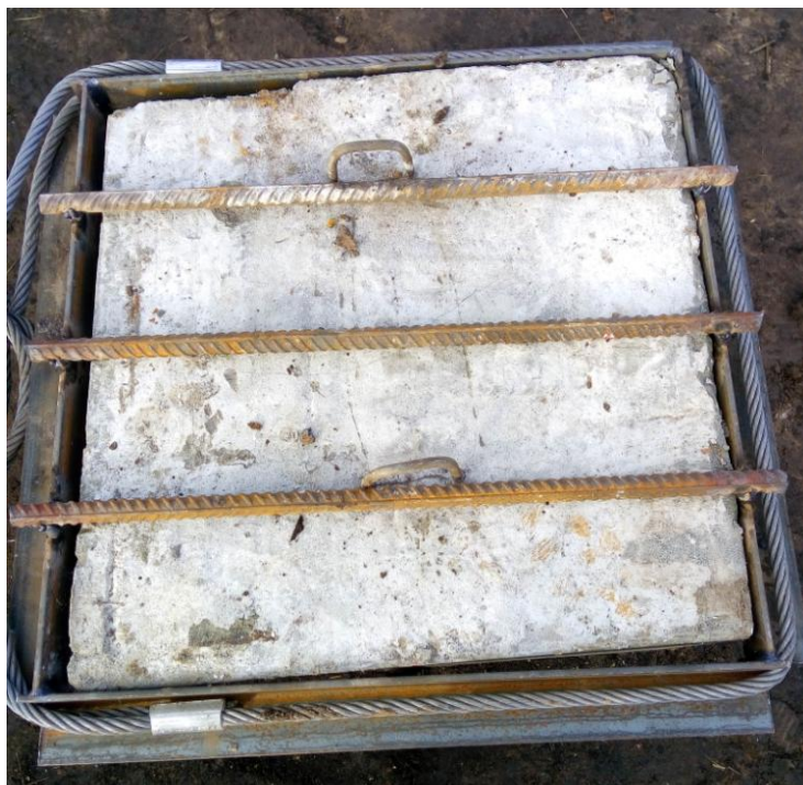
Рисунок В.29 – Устройство металлической обоймы и троса
