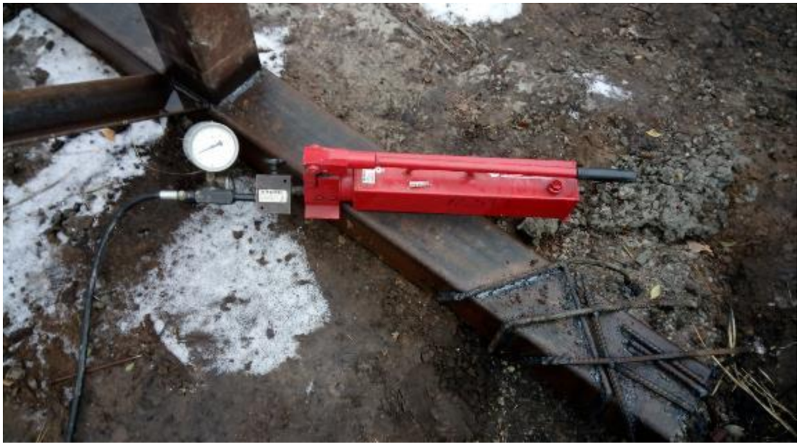
Рисунок В.23 – Ручной гидравлический насос НРГ7007
