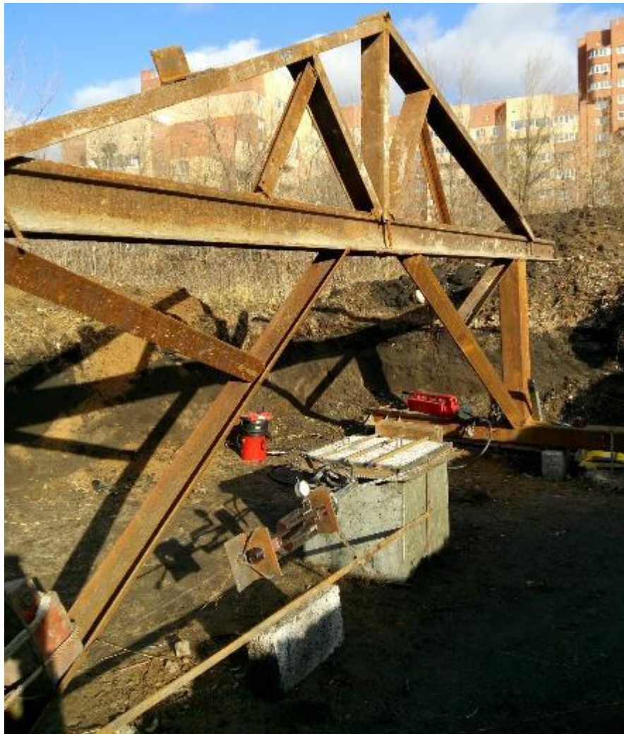
Рисунок В.27 – Испытание железобетонной плиты статической горизонтальной нагрузкой и изгибающим моментом
