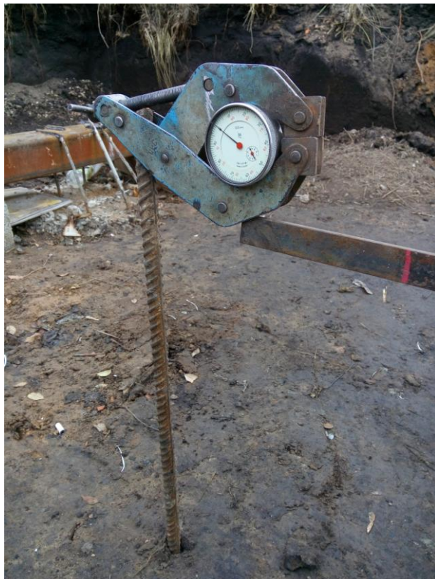
Рисунок В.26 – Индикатор часового типа ИЧ-10 для контроля осадки
