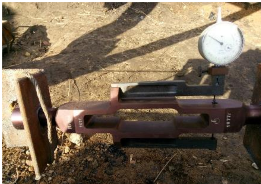
Рисунок В.28 – Динамометр ДОР-10
