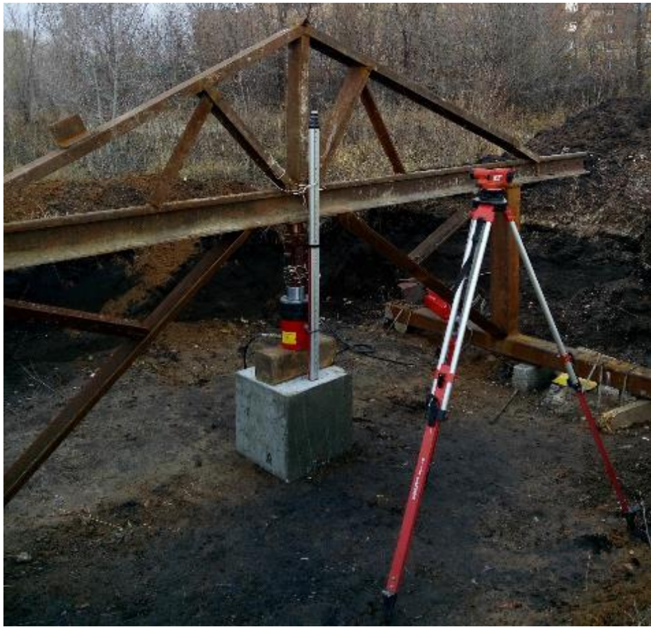
Рисунок В.25 – Испытание плиты статической вдавливающей нагрузкой
