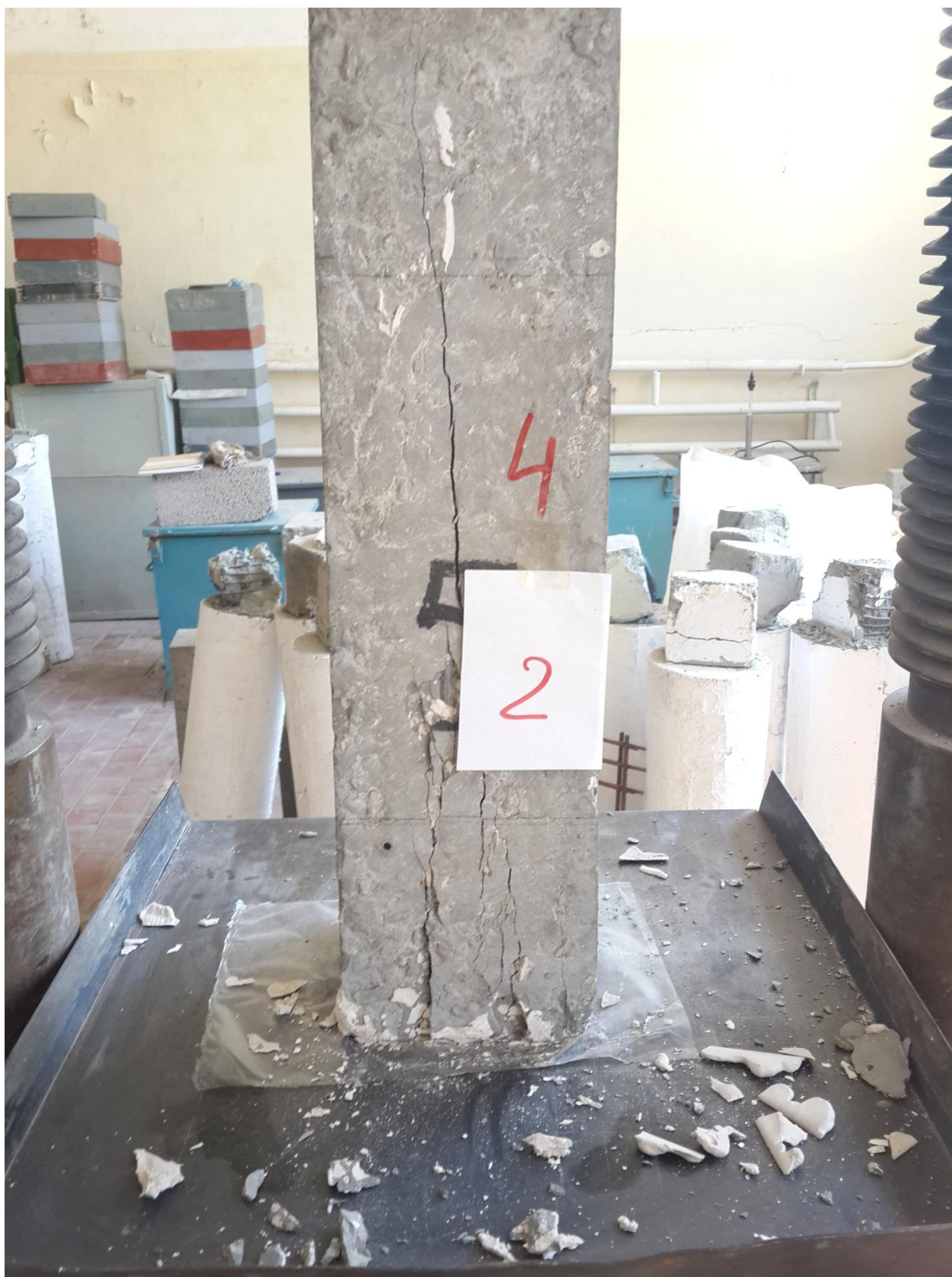
Рисунок А.5 - Результаты испытания опытного образца №2
